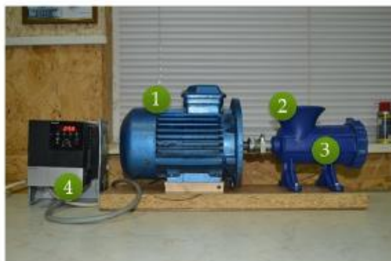
Рисунок 9 – Загальний вигляд експериментальної установки: 1 – електродвигун АІР80В6; 2 – приймальна горловина; 3 – гранулятор; 4 – частотний перетворювач Mitsubishi S 500
