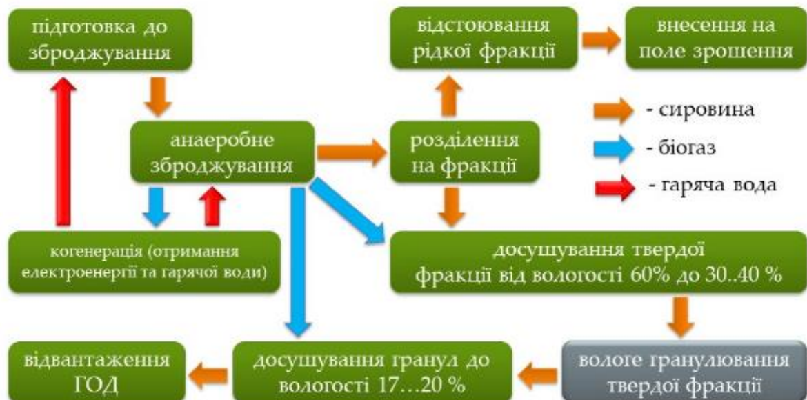
Рисунок 3 – Технологічна схема ресурсозберігаючої технології переробки твердої фракції гною свиней на гранули
