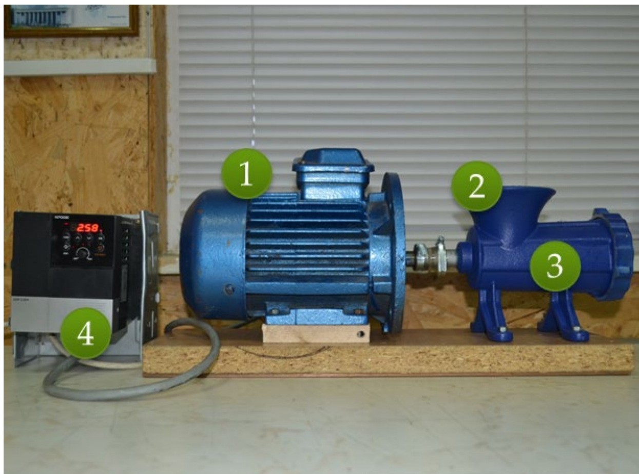
Рисунок 3.1 – Загальний вигляд експериментальної установки: 1 – електродвигун AIR80B6; 2 – приймальна горловина; 3 – гранулятор; 4 – частотний перетворювач Mitsubishi S 500
