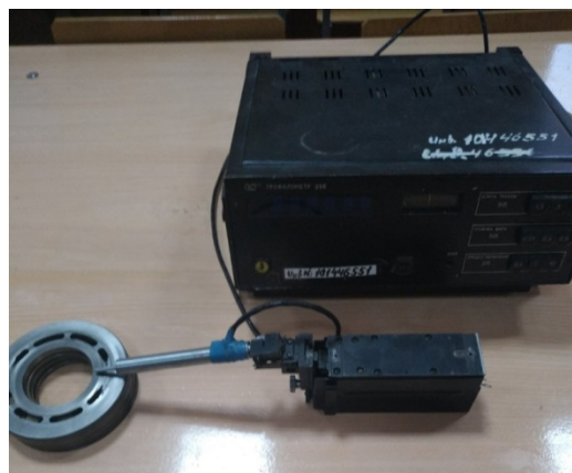
Рис. 3.1 – Вимірювання зношення робочої поверхні приставного дна профілометром моделі 296
