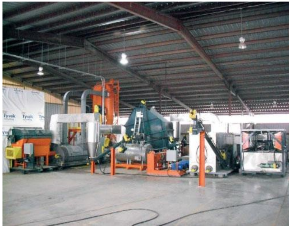
Рисунок 1.8 – Промислова установка реактора піролізу зі шнеком
