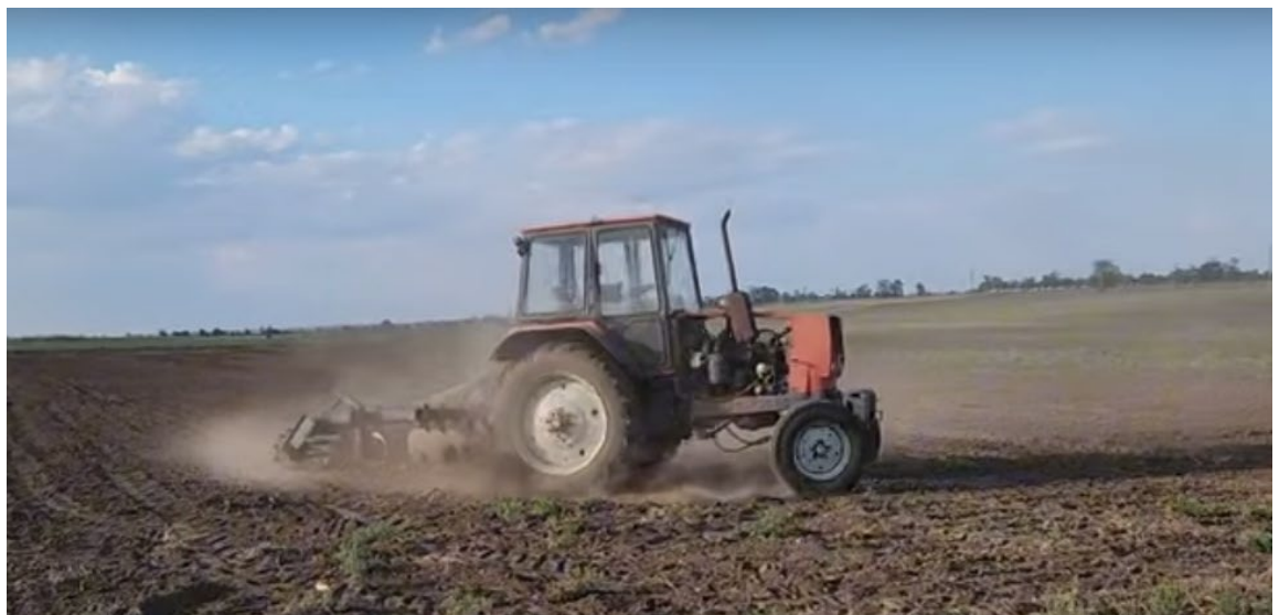
Рисунок 3.8 – Полові дослідження підвіски сидіння трактора ЮМЗ-8040 в агрегаті з дисковою бороною АУГ-2,4.
