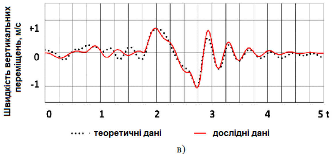
Рисунок 3.6 - Результати експериментального дослідження швидкості вертикального переміщення різних частин трактора: а – швидкість переміщення передньої вісі трактора при переїзді одиночних нерівностей; б – швидкість переміщення сидіння трактора при переїзді одиночних нерівностей; в – швидкість переміщення задньої вісі трактора при переїзді одиночних нерівностей
