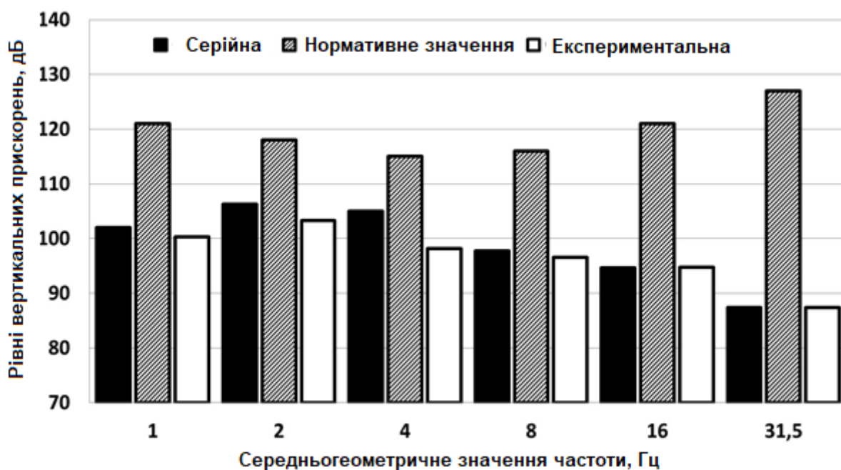
Рисунок 3.12 – Польові дослідження роботи підвіски сидіння трактора ЮМЗ-8040 в агрегаті із причепом 2ПТС-4 на швидкості 15 км/год.
