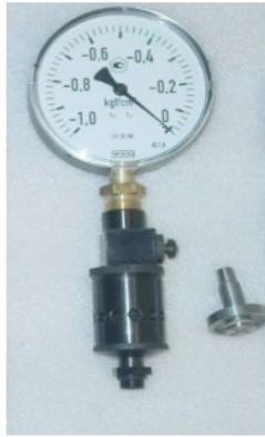
Рисунок 3.5 – Прилади комплексу АГЦ: вакуумметри Р1 і Р2
