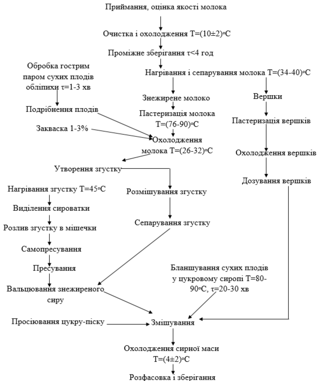
Рисунок 4.1 – Технологічна схема виробництва сиркової маси із сухими плодами обліпихи
