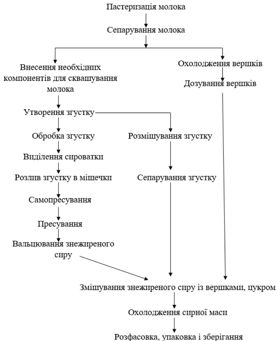
Рисунок 1.2 – Схема виробництва сиркових виробів роздільним способом
