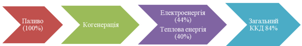
Рисунок 3.12. Схематичне представлення досягнення ККД когенераційною установкою в процесі виробництва різних видів енергії
