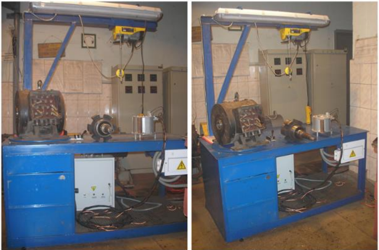
Рис. 3.1. Стенд для розбирання та складання генераторів 54 В Призначення й область застосування.
