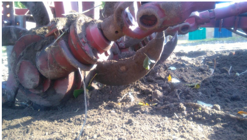
Рисунок 3.8 – Фото зубчатого деблокувального робочого органа в роботі. Після процесу викопування проведено підрахунок та заміри столових коренеплодів (рис. 3.9).
