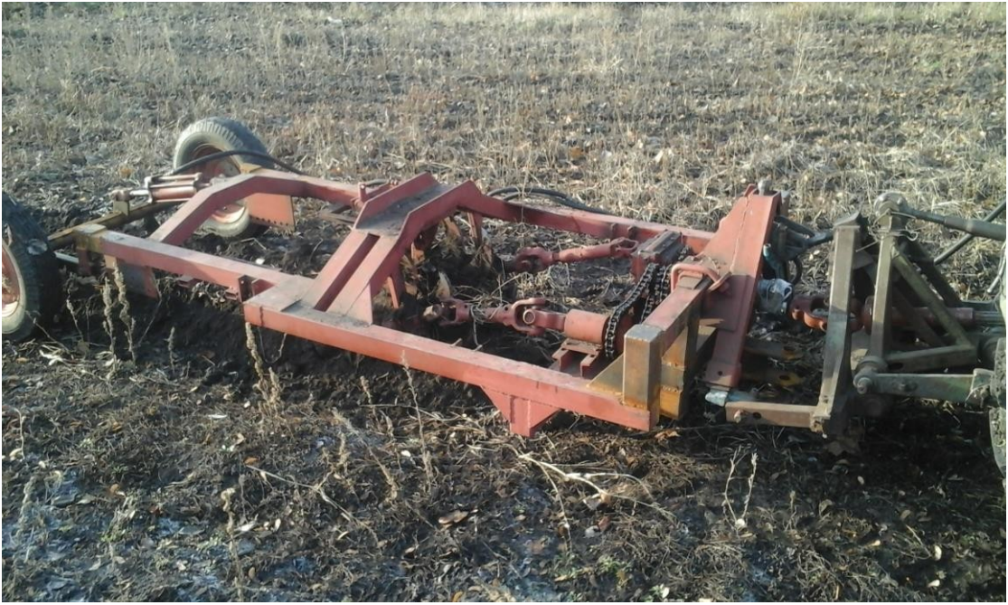
Рисунок 5.1 – Експериментальна установка для викопування довгоплідних столових коренеплодів
