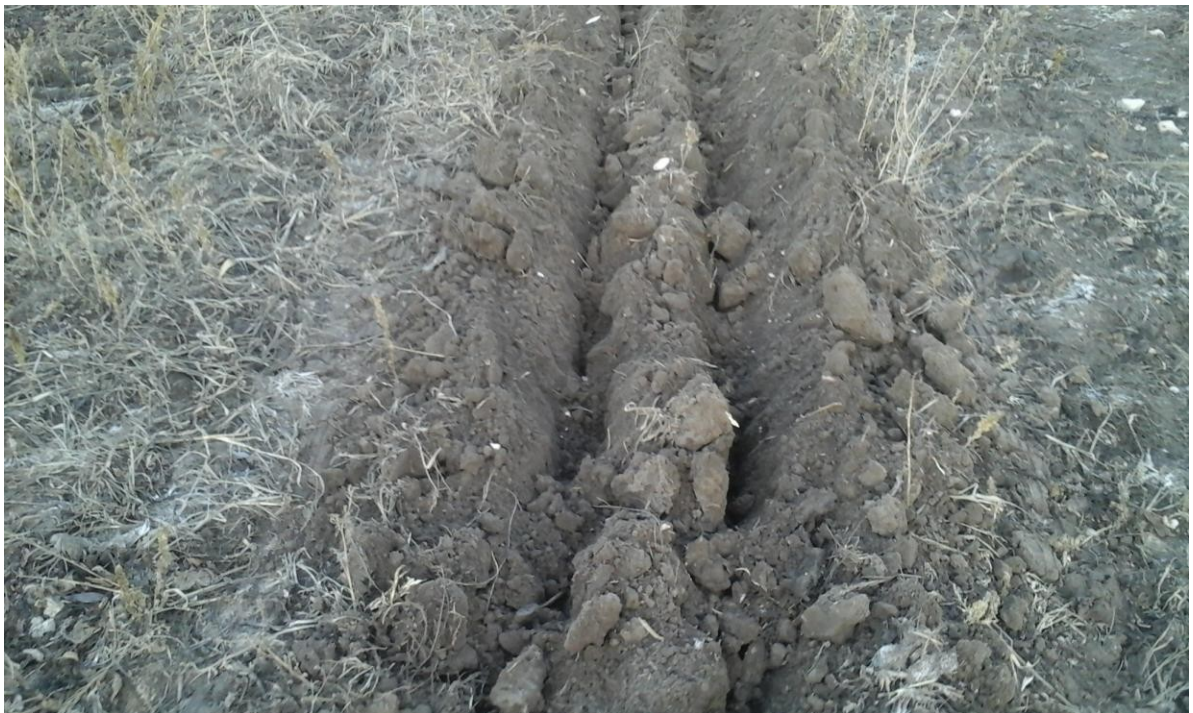
Рисунок 5.2 – Стан деблокованої канави після проходу експериментальної установки з новим робочими органами
