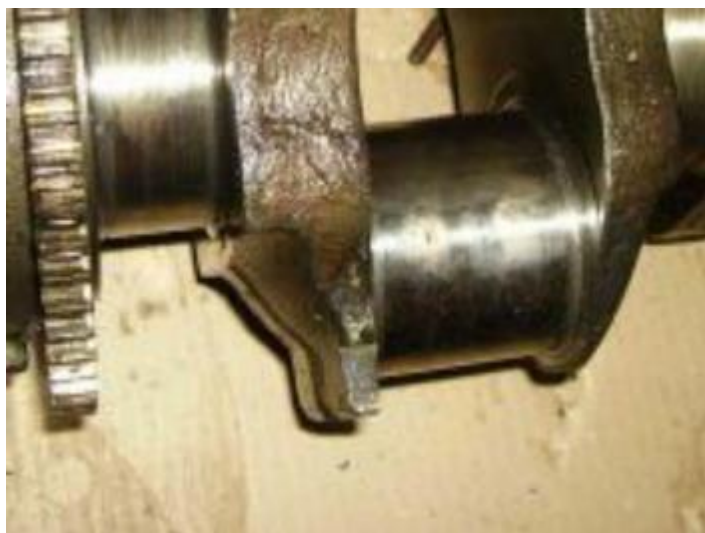
Рисунок 2.11 - Знос на шийці вала
