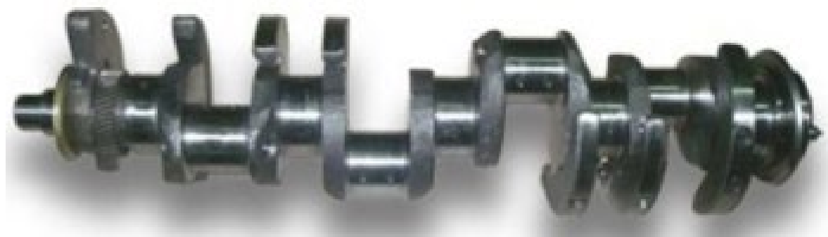
Рисунок 3.2 – Колінчатий вал ЯМЗ 238
