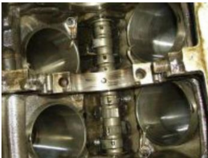
Рисунок 2.3 – Дефект у вигляді зносу блоку
