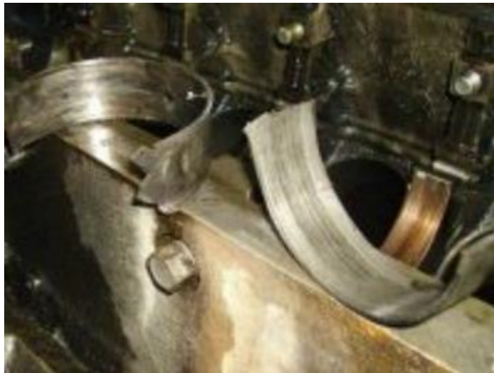
Рисунок 2.7 – Розплескання корінних вкладишів
