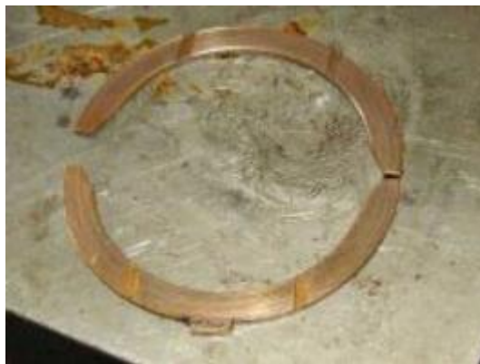
Рисунок 2.10 - Зношені опорні напівкільця
