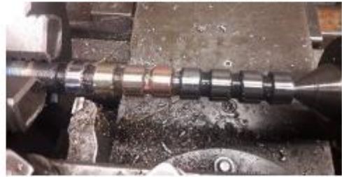
Проточка наплавлених поверхонь
