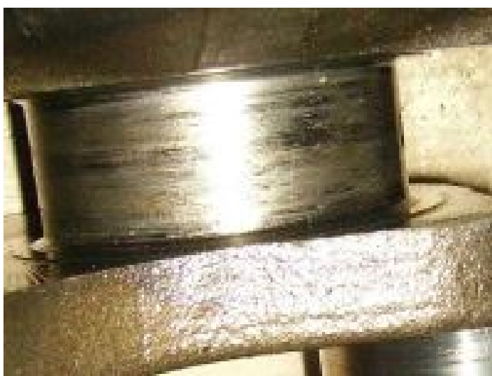
Рисунок 2.14 – Перегрів шийки вала
