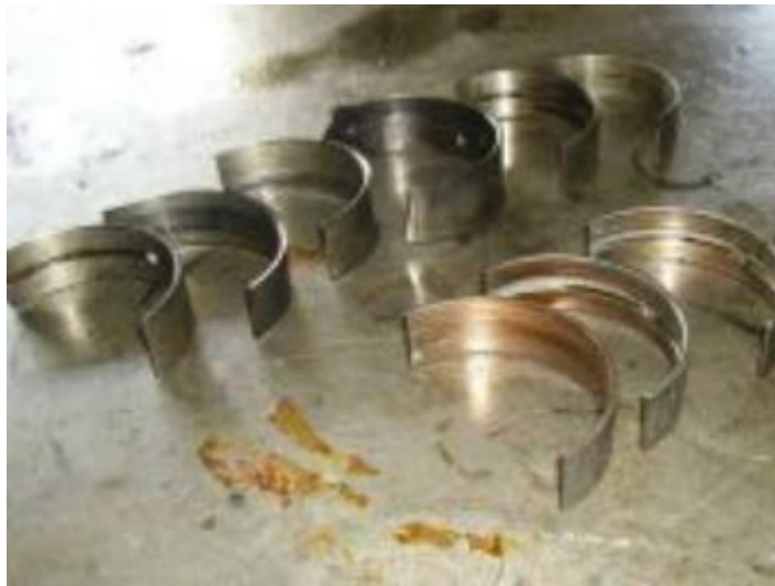
Рисунок 2.9 – Знос вкладишів першої та п'ятої опори
