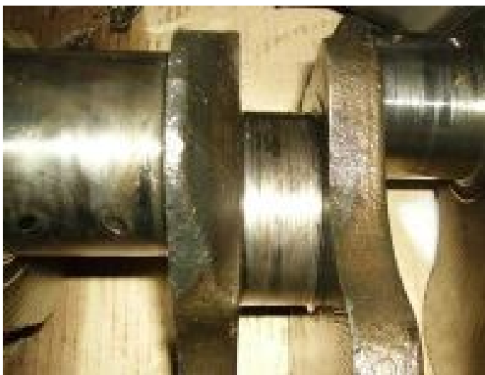
Рисунок 2.12 - Знос корінної шийки
