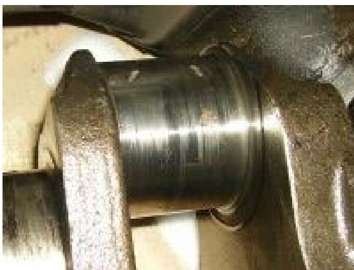
Рисунок 2.13 - Зношування шатунної шийки
