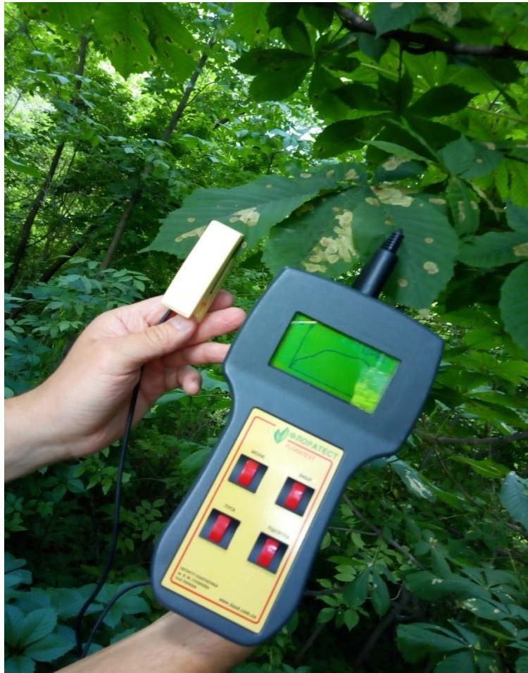
Рисунок 3.2. Портативний флуорометр «FLS 10s»
