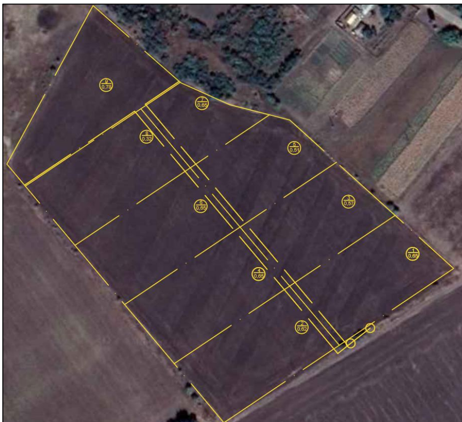
Рисунок 4.1 - Розташування зрошувальної мережі у плані
