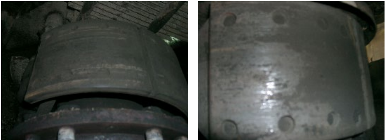
Рисунок 2.6 - Стан гальмівної колодки автомобіля МАЗ пробіг 42467 км
