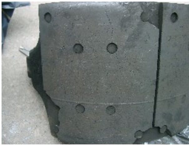
Рисунок 2.8 - Гальмівні колодки КрАЗ, який має пробіг 42467 км
