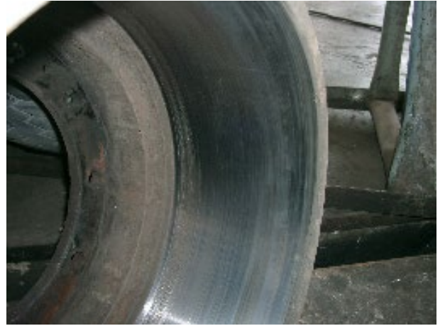
Рисунок 2.7 - Стан гальмівного барабану автомобіля МАЗ пробіг 42467 км
