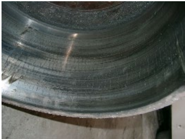
Рисунок 2.9 - Стан гальмівного барабану автомобіля КрАЗ пробіг 32641 км
