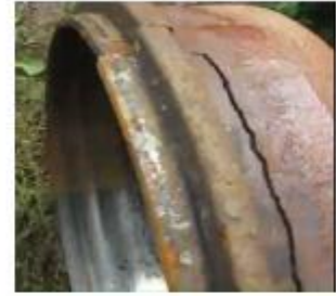
Тріщина гальмівного барабану автомобіля КамАЗ
