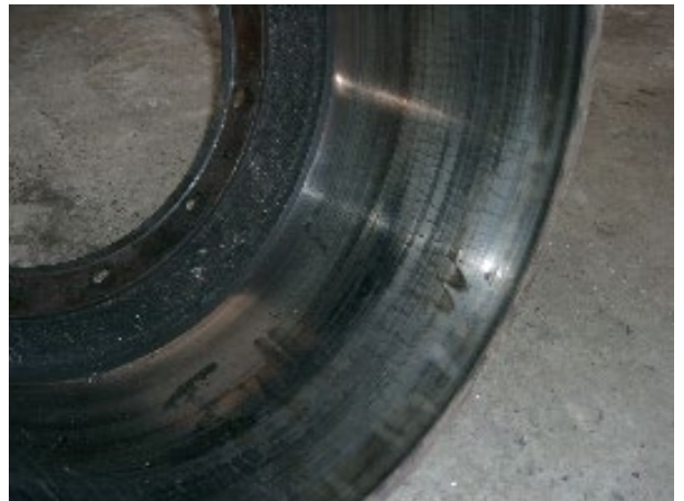
Рисунок 2.9 - Стан гальмівного барабану автомобіля КрАЗ пробіг 32641 км
