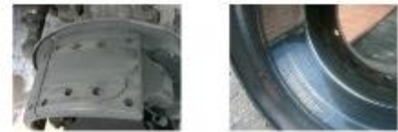
Стан гальмівного барабану автомобіля КамАЗ пробіг 44168 км
