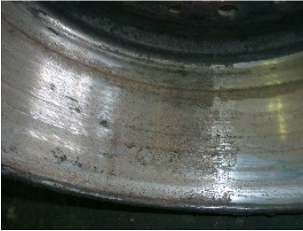
Рисунок 2.7 - Стан гальмівного барабану автомобіля МАЗ пробіг 42467 км
