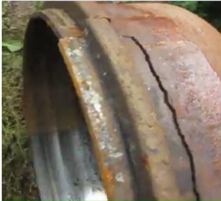
Рисунок 2.13 - Тріщина гальмівного барабану автомобіля КраЗ
