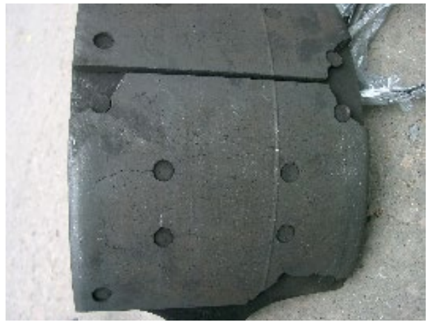
Рисунок 2.8 - Гальмівні колодки КрАЗ, який має пробіг 42467 км
