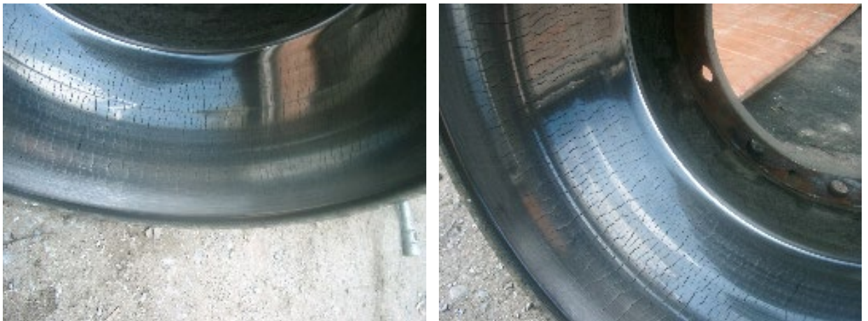
Рисунок 2.11 - Гальмівний барабан КрАЗ, який має пробіг 44168 км
