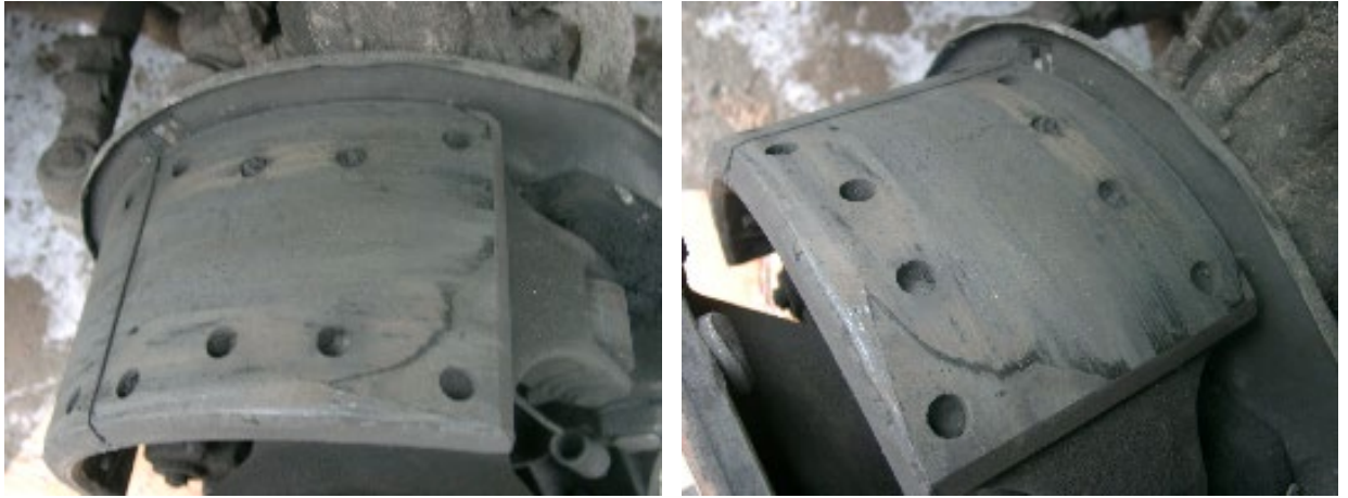
Рисунок 2.10 - Гальмівні колодки КрАЗ, який має пробіг 44168 км
