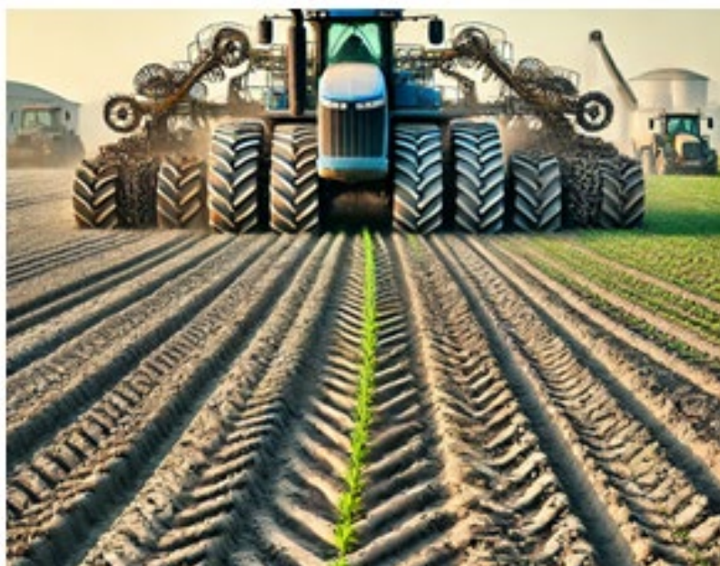
Рисунок 1.1 – Ущільнення ґрунту рушійними сільськогосподарської техніки [4]
