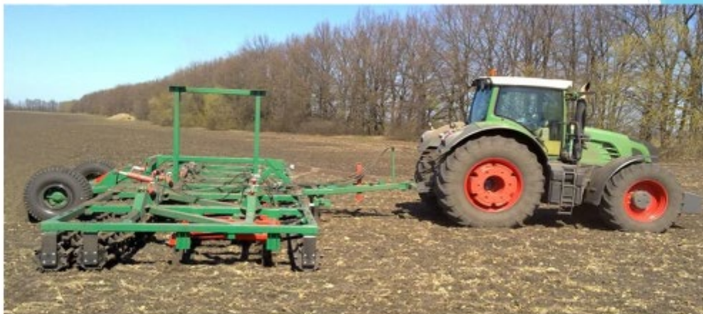
Культиватор КВАНТ-12, укомплектований виготовленими і зміцненими робочими органами для проведення випробувань в польових умовах
