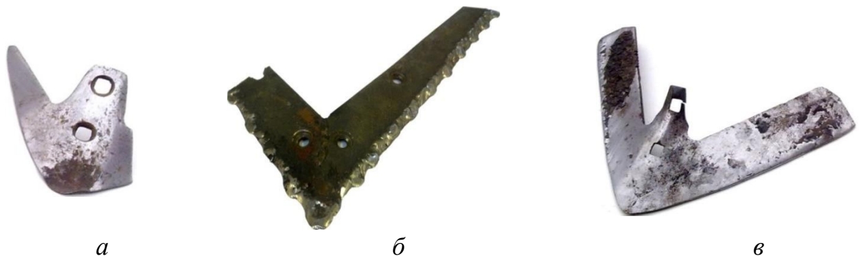
a – відлом крила культиваторної лапи КПС-270; б – відлом крила в місці кріплення лапи культиватора КВАНТ–12; в – протирання місця кріплення відновленої культиваторної лапи КПС-330
