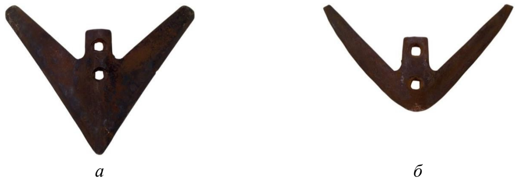
Рисунок 1.8 – Загальний вигляд нової (а) та зношеної (б) культиваторної лапи КПС 330мм в умовах чорноземних ґрунтів
