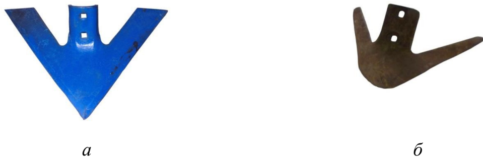
Рисунок 1.5 – Загальний вигляд нової (а) та зношеної (б) культиваторної лапи КПЕ-410 в умовах піщаних ґрунтів
