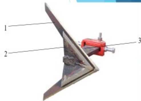
1 – культиваторна лапа КВАНТ-12; 2 – нижня частина культиваторної стійки; 3 – стійка культиваторної лапи
