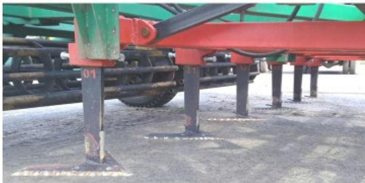
Загальний вигляд лап культиватора КВАНТ-12 після наробітку 55 га на один робочий орган
