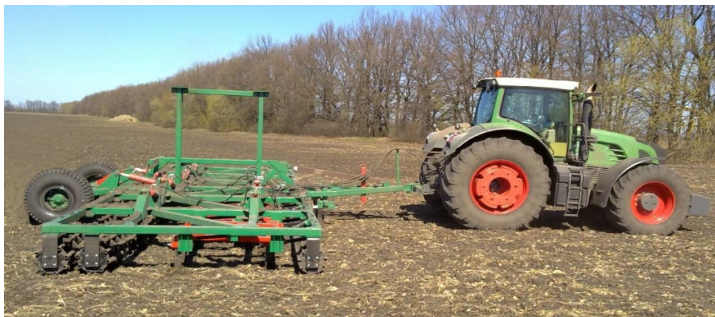
Рисунок 3.3 – Культиватор КВАНТ-12, укомплектований виготовленими і зміцненими робочими органами для проведення випробувань в польових умовах
