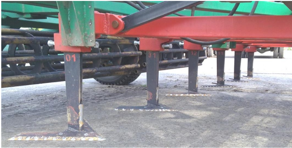
Рисунок 3.3 – Загальний вигляд лап культиватора КВАНТ-12 після наробітку 55 га на один робочий орган
