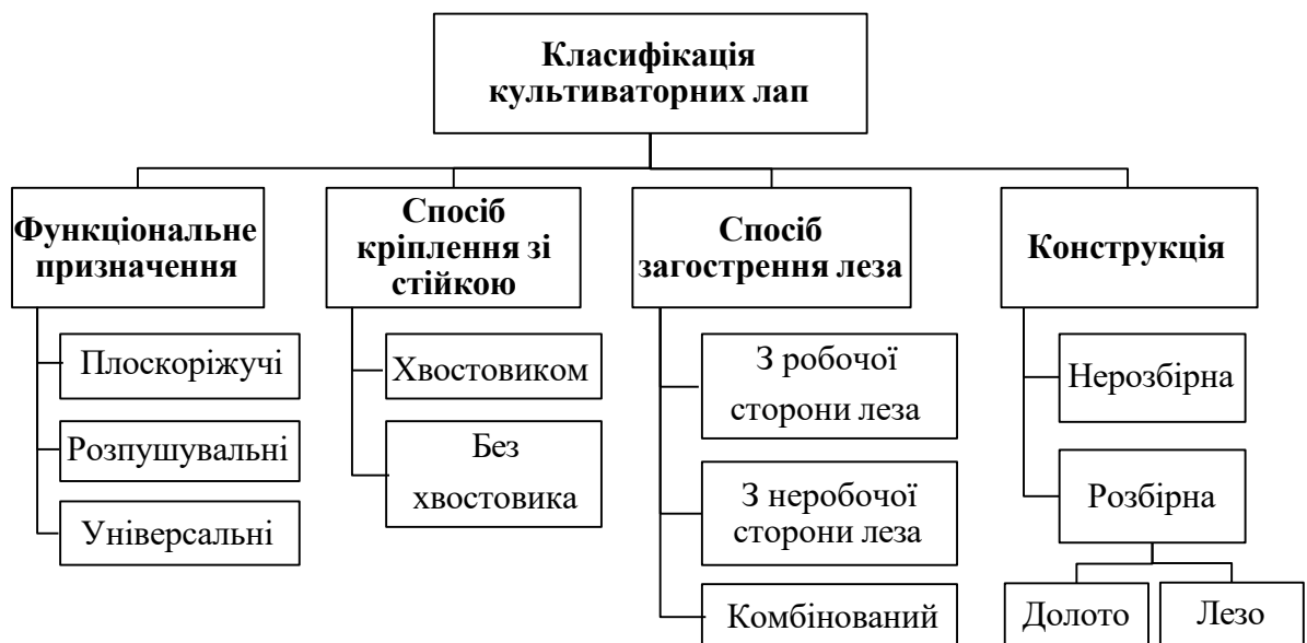
Рисунок 1.3 – Класифікація культиваторних лап
