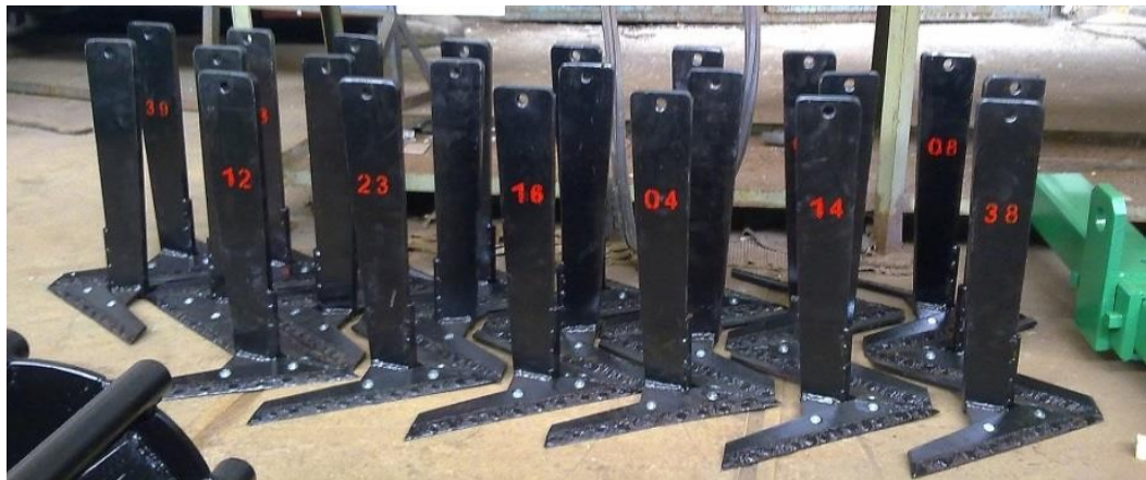
Рисунок 3.2 – Загальний вигляд ряду робочих органів зміцнених для культиваторів КВАНТ-12
