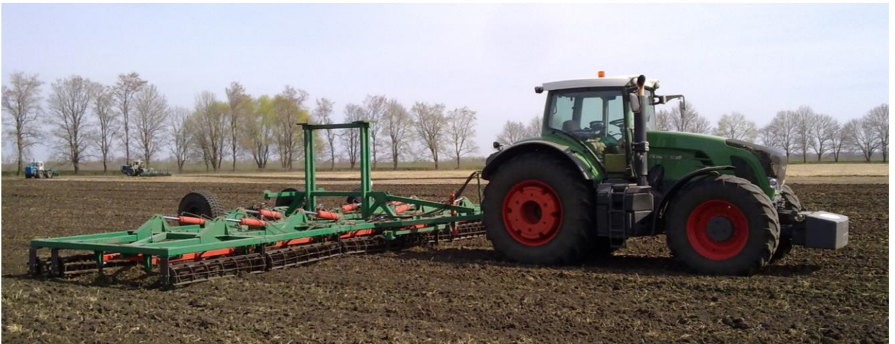
Рисунок 3.1 – Загальний вигляд культиватора КВАНТ–12 агрегатованого з трактором Fendt 936 Vario
