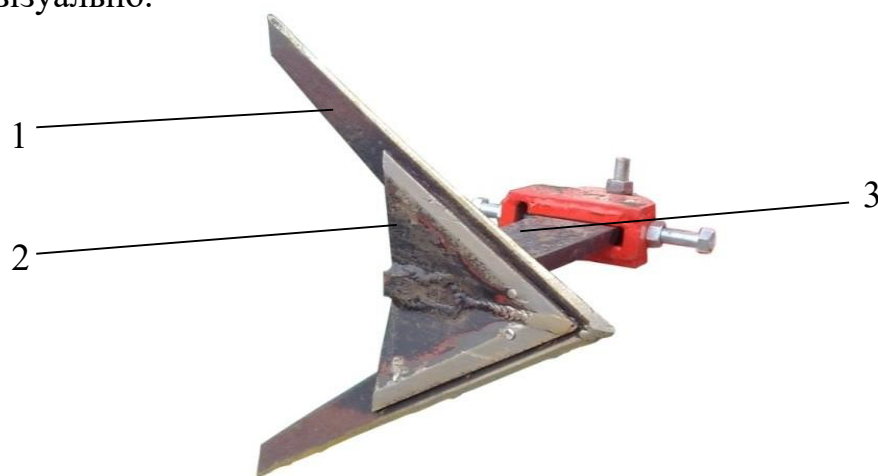
1 – культиваторна лапа КВАНТ-12; 2 – нижня частина культиваторної стійки; 3 – стійка культиваторної лапи
