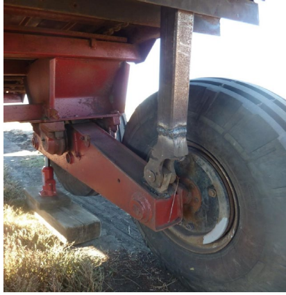
Рисунок 3.3 – Імітація системи перерозподілу навантаження на навіску трактора
