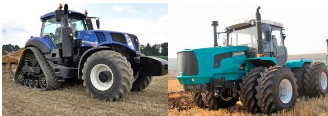
Рисунок 1.9 – Підвищення тягових показників трактора шляхом модернізації ходової частини
