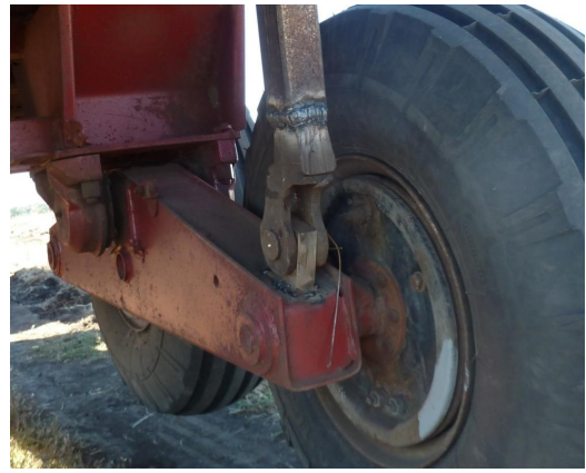
Рисунок 3.3 – Імітація системи перерозподілу навантаження на навіску трактора
