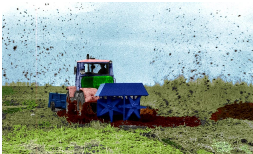
Рисунок 1.1 – Розподілення органічних добрив навісним розкидачем РУН-15
