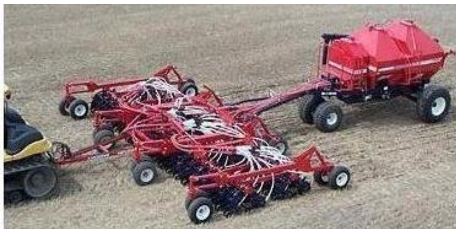
Рис. 2.10. Пневматична сівалка Never Pin виробництва Morris
