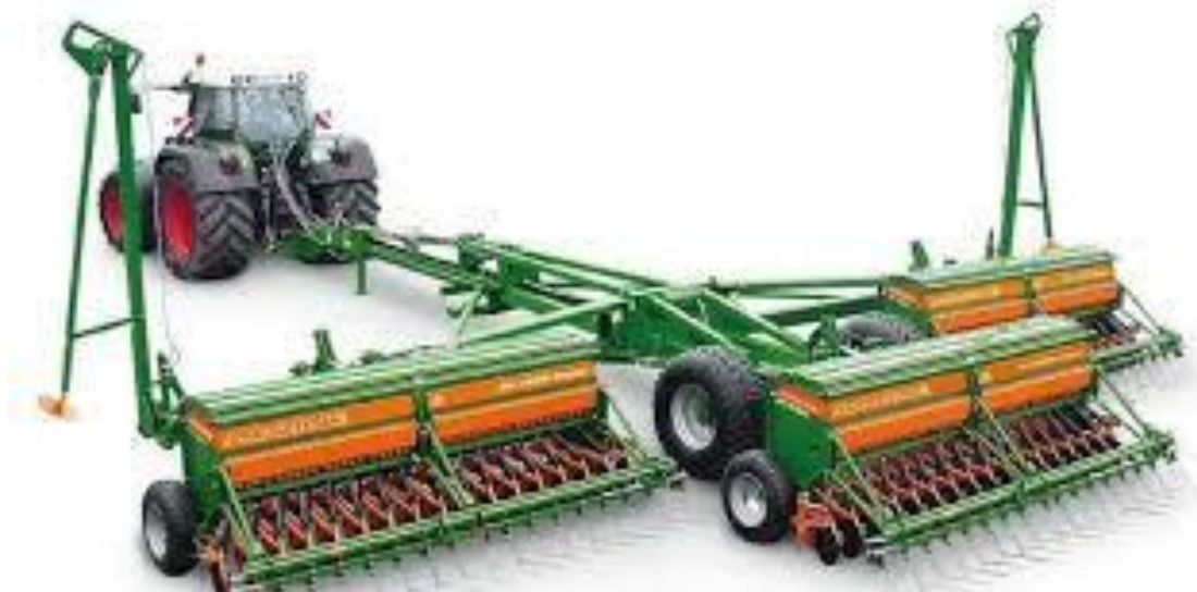
Рисунок 2.2. Сівалка D9-120 зі складною зчіпкою в робочому положенні
