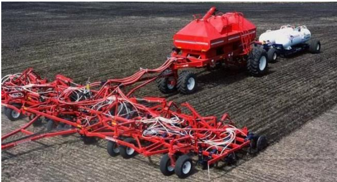
Рис. 2.11. Сівалка-культиватор Maxim II виробництва Morris
