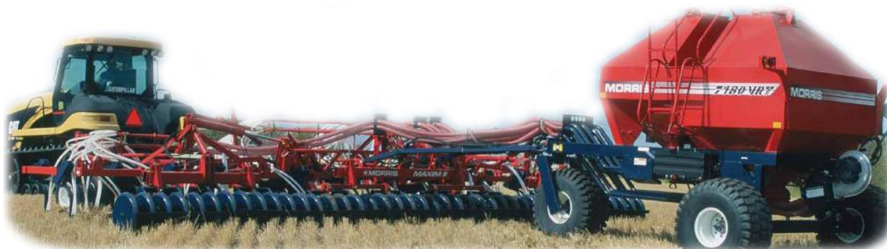
Рис. 2.5. Пневматична сівалка XPRESS виробництва Morris Industries
