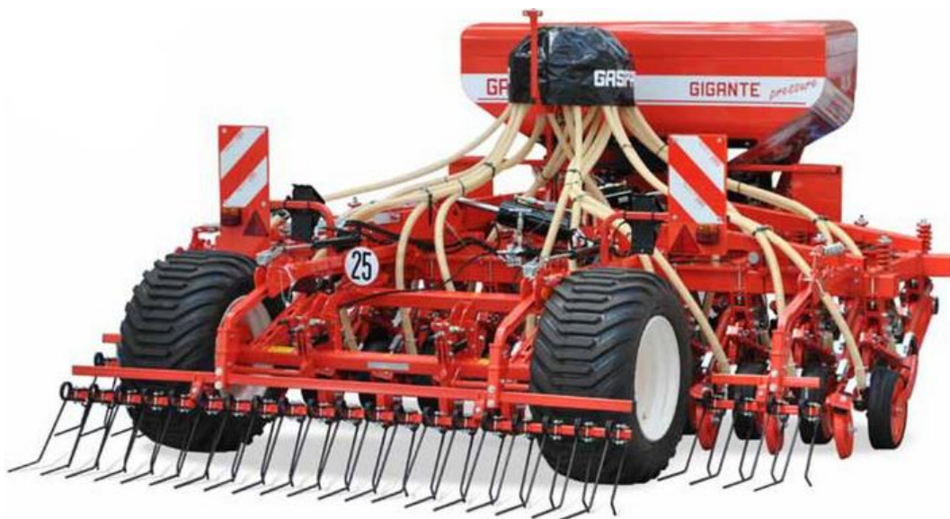
Рис. 2.8 Пневматичну сівалку Gigante 900 виробництва Gaspardo
