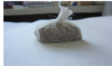
Рис. 3.3 – Підготовка ґрунту до проварювання
