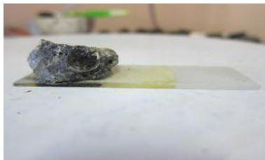
Рис. 3.4 – Підготовка ґрунту до шліфування
