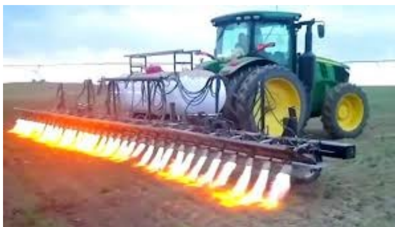
Рисунок 1.6 – Вогневий спосіб знищення бур'янів
