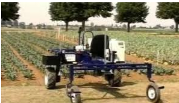
Рисунок 1.9 – Самохідна платформа для проведення моніторингу розвитку рослин компанії «ТНТ»
