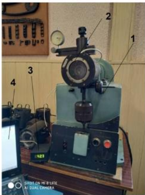
Лабораторна установка ДМ 28 1 – установка, 2 – модернізована камера для моделювання зазорів і натягів у з'єднанні підшипник – корпус, 3 – пристрій вимірювання температури, 4 - ПК
