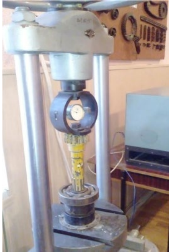
Рисунок 3.9 – Випробування з'єднання на осьовий зсув
