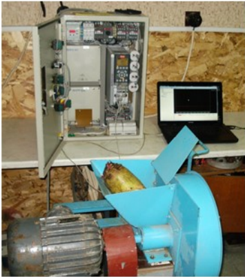
Рисунок 8 – Стенд на основі малогабаритного подрібнювача, оснащеного експериментальним ріжучим апаратом
