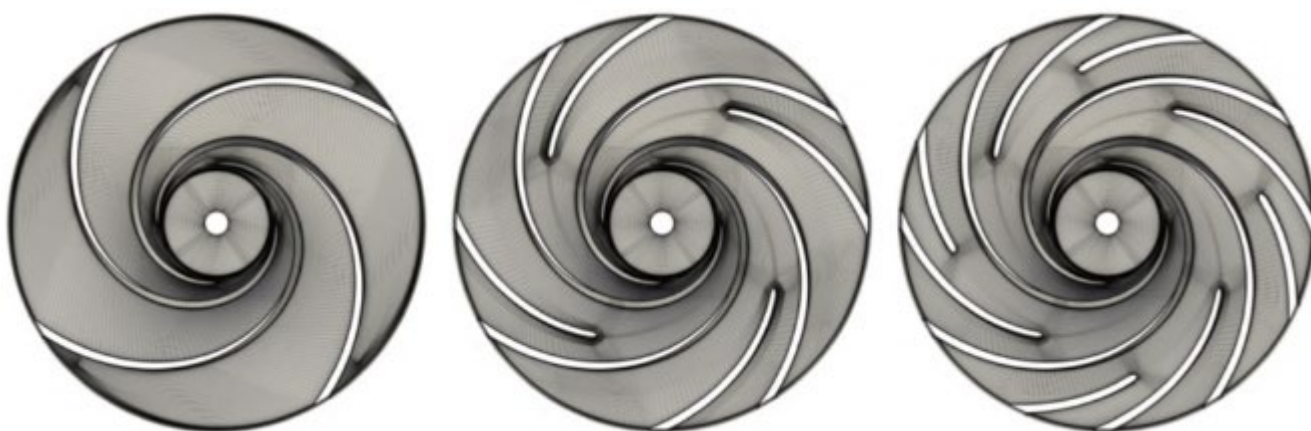
Рисунок 3.7 – Вид сітки ротору для випадків 0sp, 1sp і 2sp.
