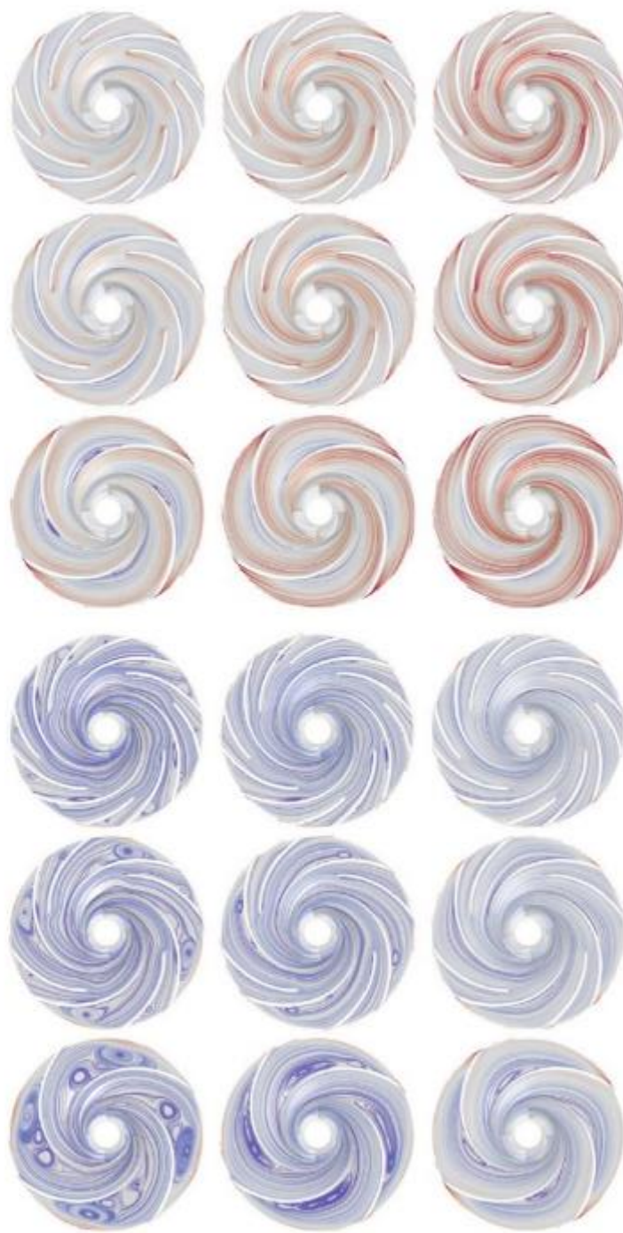
Линії потоку середнього значення за часом Зліва направо: Варіант 0sp, Варіант 1sp, Варіант 2sp Зверху вниз: Q = 100\% Q_{\Phi} , Q = 130\% Q_{\Phi} , Q = 160\% Q_{\Phi}
