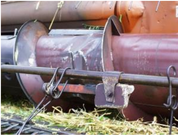
Рисунок 3.7 - Попадання сторонніх предметів під шнек жатки.
