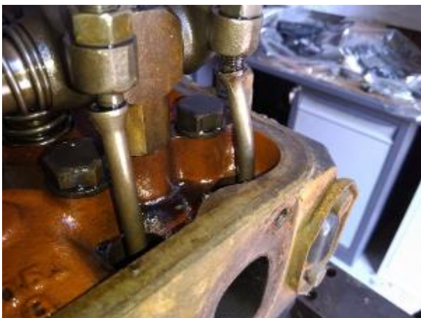
Рисунок 3.9 - Експлуатаційна відмова погнуті штанги двигуна
