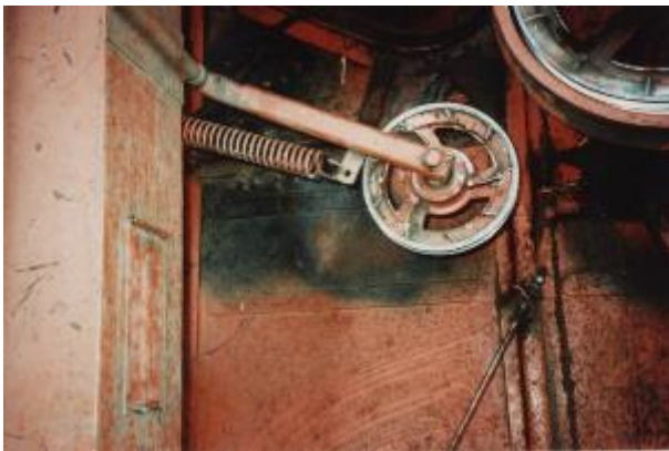
Рисунок 3.7 - Попадання сторонніх предметів під шнек жатки.
