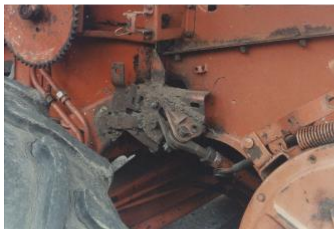
Рисунок 3.3 - Тріщина рами і обрив кронштейнів з правого боку комбайна
