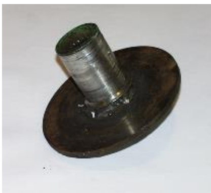
Рисунок 3.6 - Технологічний недолік – а -в шліцьовій муфті відсутній розріз і отвір для стяжного болта. б - обрив фланця запобіжної муфти по зварювальному шву, розсипався підшипник валу соломотрясу.
