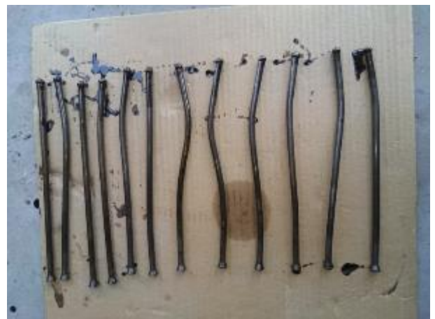
Рисунок 3.9 - Експлуатаційна відмова погнуті штанги двигуна
