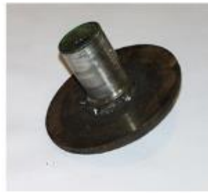
Обрив фланця запобіжної муфти по зварювальному шву
