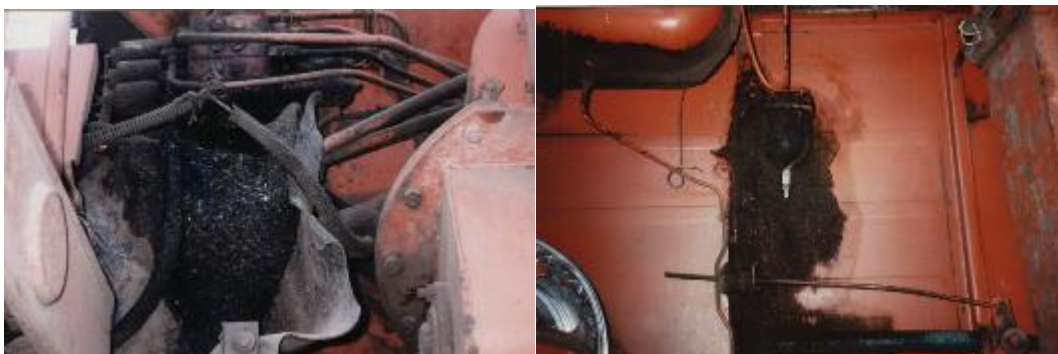
Рисунок 3.5 - Конструктивний недолік - підтікання олив і палива із стиків з'єднань трубопроводів.
