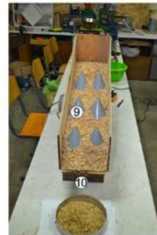
Рисунок 10 – Вібраційний змішувач вид збоку (а) та вид з переду (б): 1 – віброжолоб; 2 – електродвигун АІР 56 А2; 3 – ресора; 4 – опорна рама; 5 – передня стійка; 6 – задня стійка; 7 – частотний регулятор Mitsubishi S 500; 8 – поворотна рама; 9 - змішуючі органи конічної форми; 10 – поворотний механізм.
