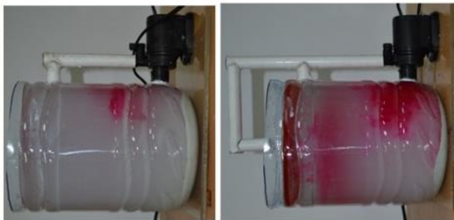
Рисунок 13 - Динаміка зміни концентраційних полів для метантенка з типовою (а) і модернізованою (б) системами перемішування (модель отримана в COMSOL Multiphysics)
