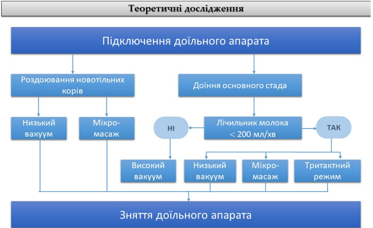
Рисунок 3 - Алгоритм роботи експериментального доїльного апарата
