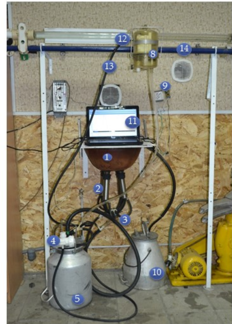
Рисунок 6 - Схема лабораторної установки: 1 - штучне вим'я; 2 - доїльні стакани; 3 - колектор; 4 - вібропульсатор; 5 - доїльне відро; 6 - регулятор вакууму; 7 - вакуумметр; 8 - блок керування вакуумом; 9 - АЦП NI USB 6008; 10 - ємність з водою; 11 - ПЕОМ; 12 - вакуумний кран; 13 - вакуумний шланг; 14 - вакуумпровід
