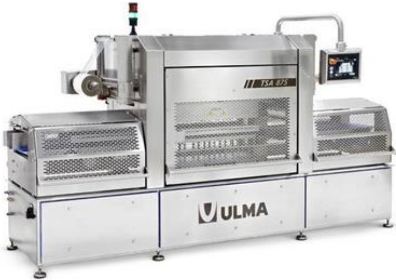
Рис. 32. Машина для пакування MAP у високошвидкісній модифікованій атмосфері ULMA [29]
