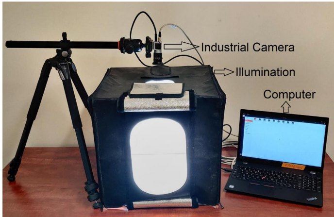
Рис. 1. Типова система комп'ютерного зору для програм неруйнівної оцінки якості м'яса [1]
