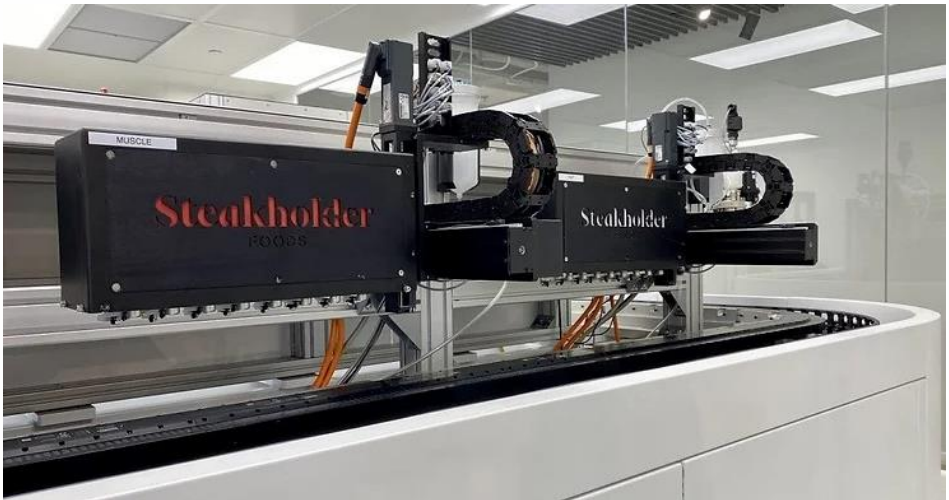
Рис. 27. Високопродуктивний біопринтер компанії Steakholder Foods, Ізраїль [24]
