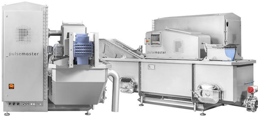
Рис. 20. Компактна система PEF від Pulsemaster обробляє до 10 т/год. Призначений для малої та середньої виробничої лінії [17]
