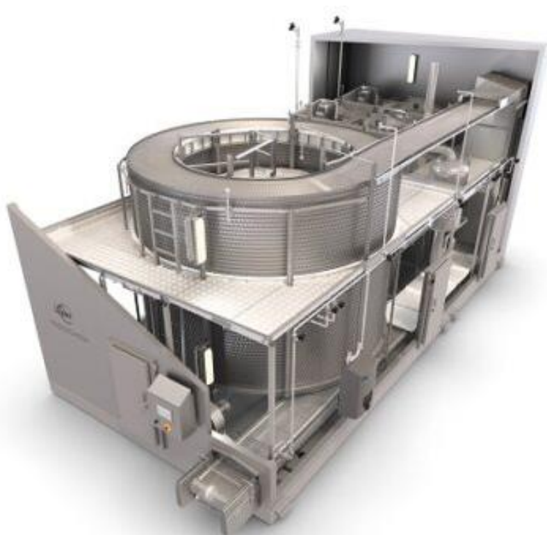
Рис. 7. Спиральна морозильна камера Frigoscandia GC70 [5]
