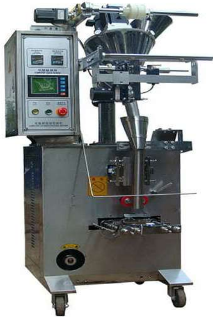
Рис. 85. Автоматична машина для зважування та пакування рибного борошна[22]
