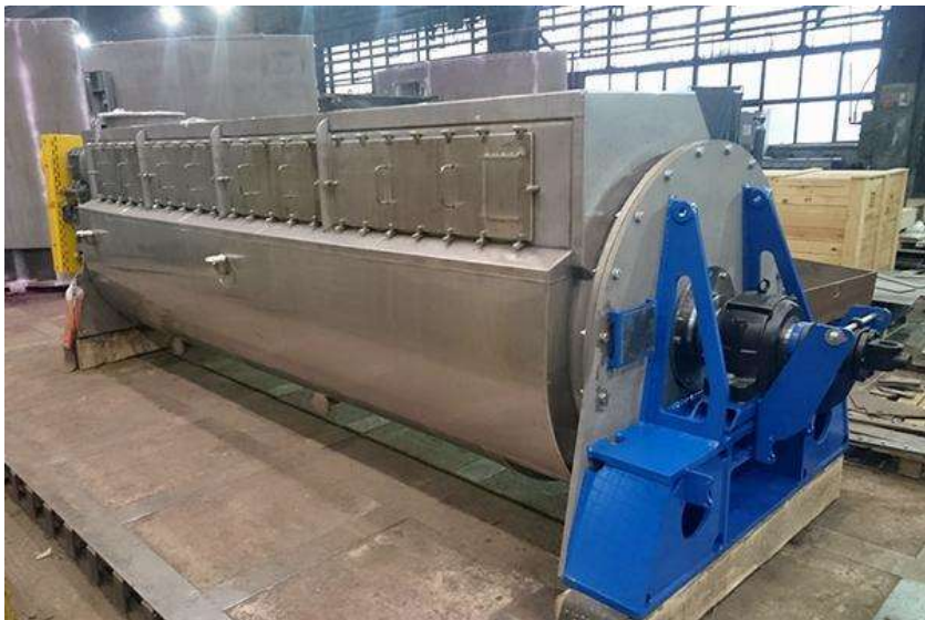
Рис. 78. Термальна дискова сушарка AMOF-Fjell технологічна схема а), загальний вигляд б) [22]
