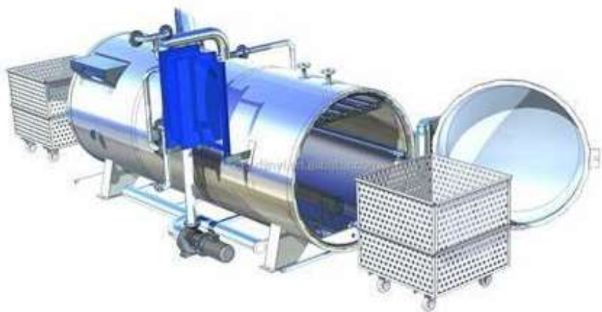
Рис. 2. Схематичне зображення резервуара для обробки високим тиском морепродуктів а) і резервуар для обробки високим тиском морепродуктів б) [18]
