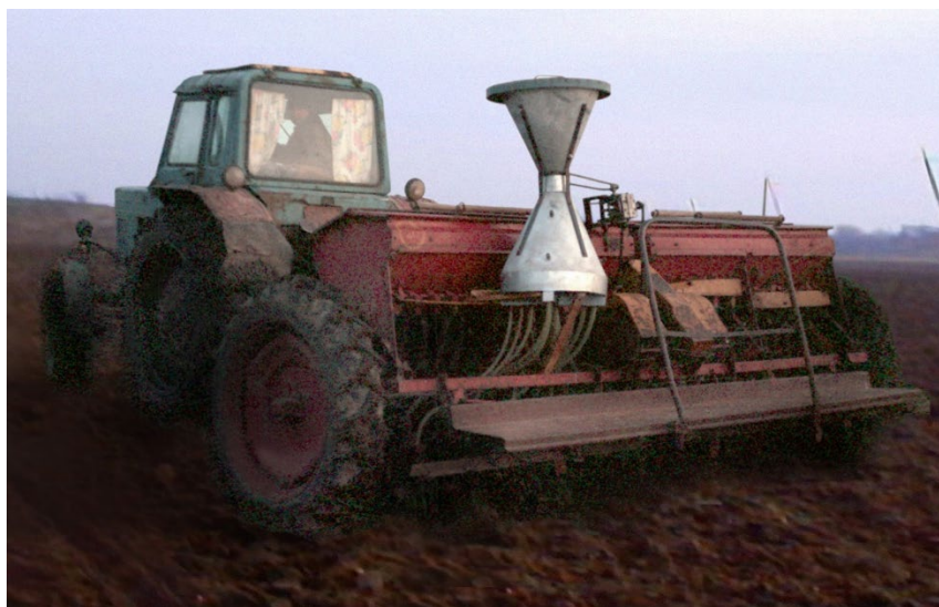
Рисунок 3.7 – Експериментальні дослідження висівного апарату барабанного типу в польових умовах
