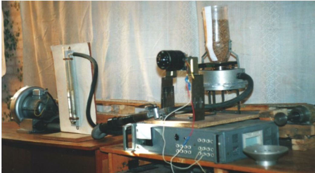
Рисунок 3.2 – Загальний вигляд експериментальної установки висівного апарата барабанного типу пневматичної сівалки
