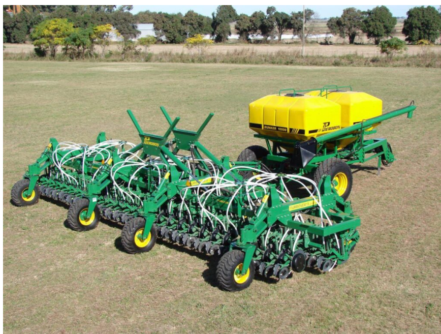
Рисунок 1.6 – Посівний комплекс Turbosem 2 (Агро-Союз)
