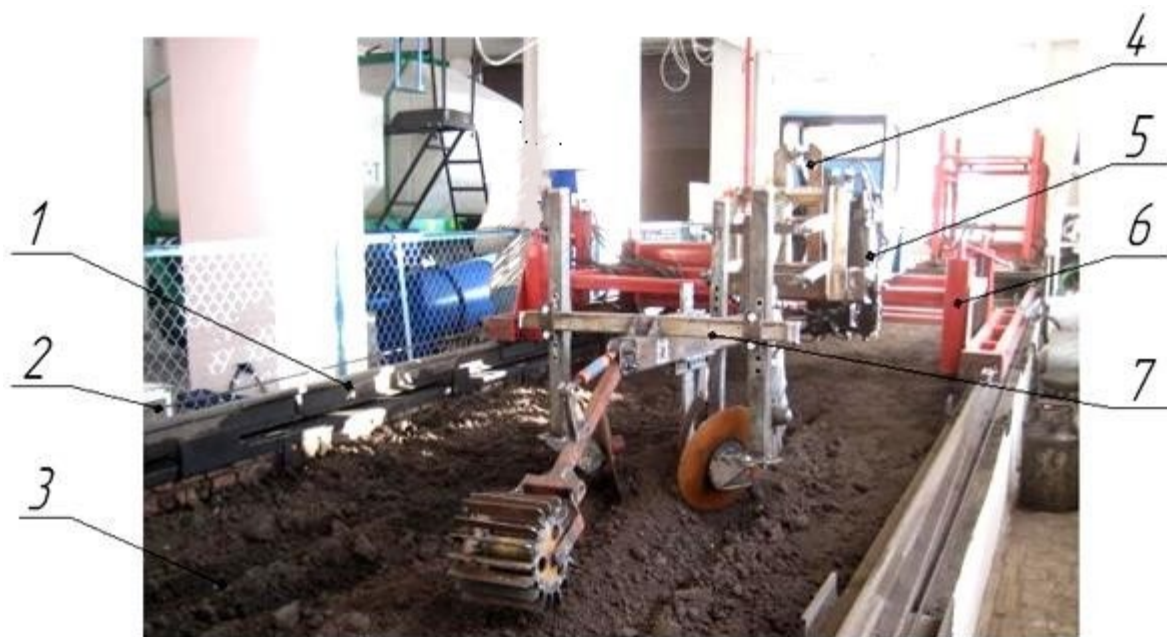
Рисунок 3.1 – Лабораторна установка для визначення тягового опору
