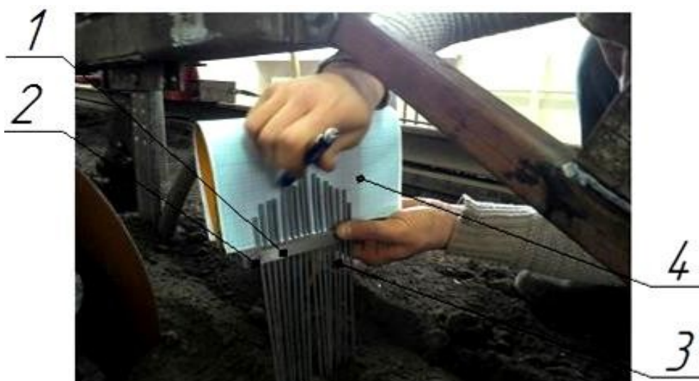
Рисунок 3.5 - Спосіб визначення профілю оброблюваної смуги 1 - штатив; 2 - кріплення; 3 - стрижні; 4 - міліметровий папір
