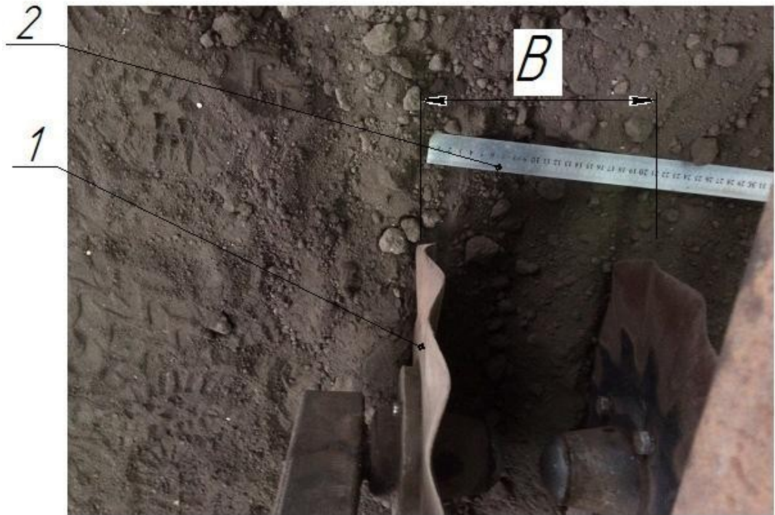
Рисунок 3.7 - Спосіб виміру ширини обробітку
