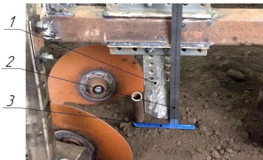
Рисунок 3.6 - Спосіб визначення середньої глибини обробітку ґрунту 1 - щілинник; 2 - вертикальна мірна лінійка; 3 – горизонтальна планка.
