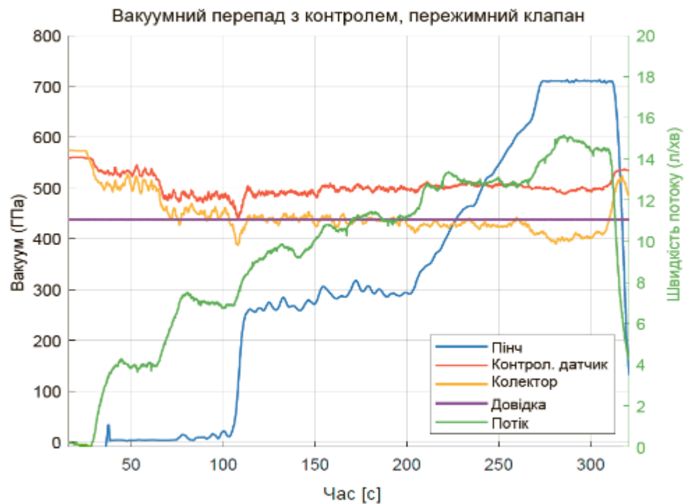
Рисунок 4.7 – Рівень вакууму в колекторі для різних витрат із постійним еталонним значенням 45 кПа
