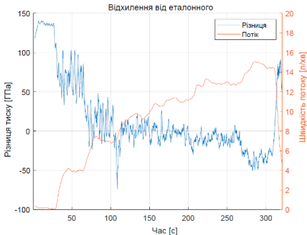
Рисунок 4.8 – Різниця тиску між вакуумом колекторі та еталонним для різних витрат
