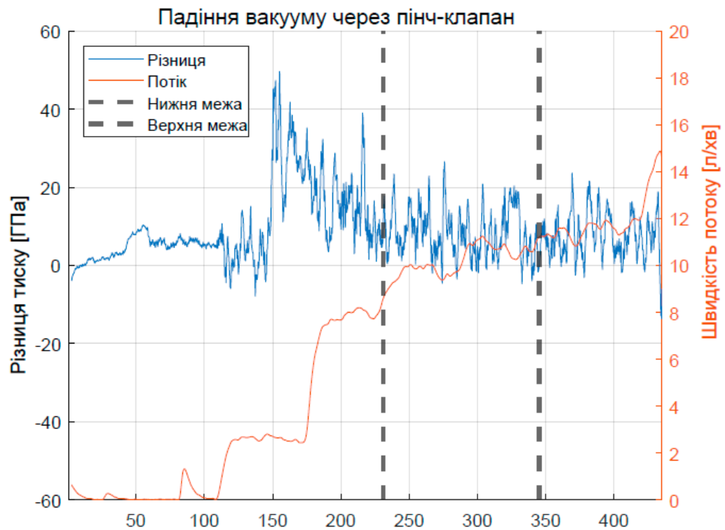
Рисунок 4.9 – Падіння вакууму над Pinch-клапаном під час випробування 1 для визначеного діапазону. Пунктирні лінії показують область, де середня швидкість потоку становить приблизно 10 л/хв
