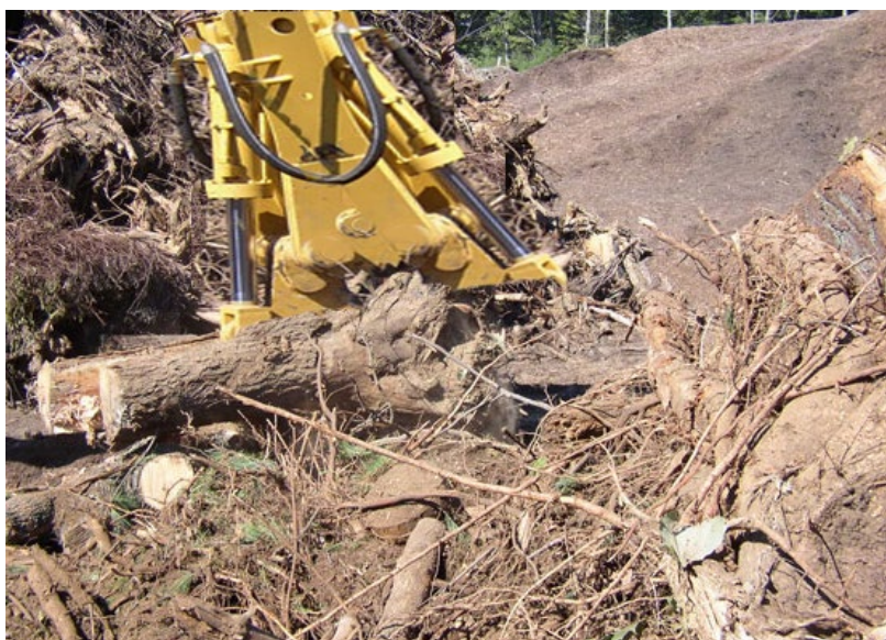
Рисунок 4.3 - Корчування пня за допомогою вібраційного корчувача.
