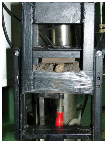
Рисунок. 3.1 - Лабораторна установка для дослідження процесу руйнування коренів дерев у ґрунті.
