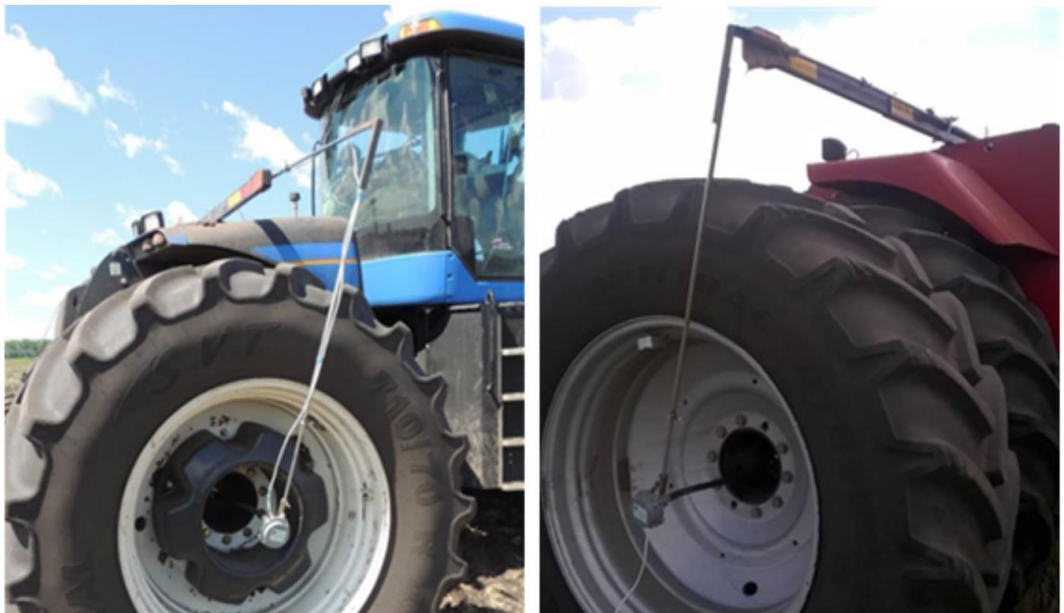
Рисунок 1.6 – Визначення буксування за допомогою датчика кута обертання ведучих коліс трактора
