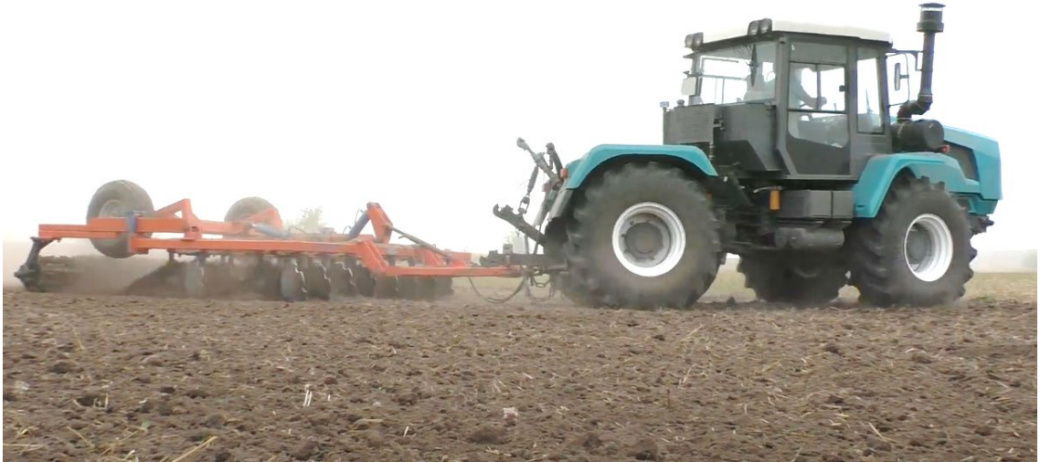
Рисунок 3.1 – Об’єкт досліджень трактор ХТЗ-243К з бороною БДВП-4,2
