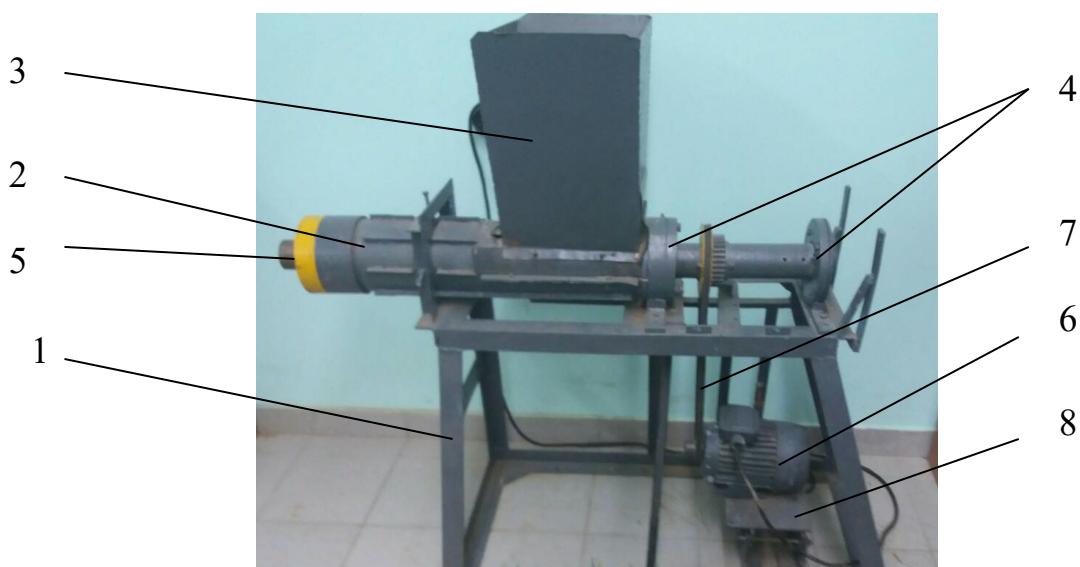
Рисунок 3.3 – Лабораторна установка для дослідження процесу дозування компостів на основі торфу
