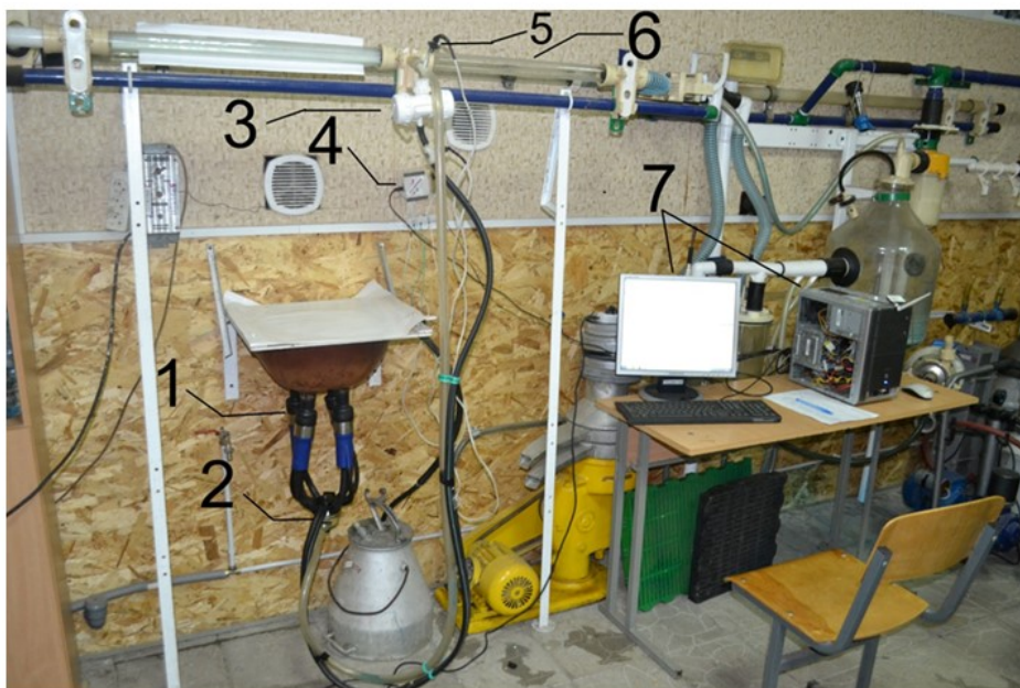
Стенд для побудови осцилограм зміни тиску в міжстінних камерах доїльних стаканів: 1 - доїльні стакани; 2 - колектор; 3 - електропульсатор; 4 - блок керування; 5 - 6- молокопровід; 7 - комп'ютер з необхідним програмним забезпеченням
