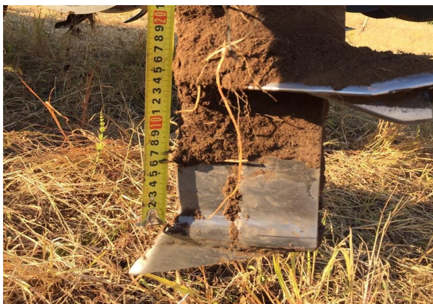
Рисунок 3.4 - Щілювач посиленої конструкції для проведення польових випробувань
