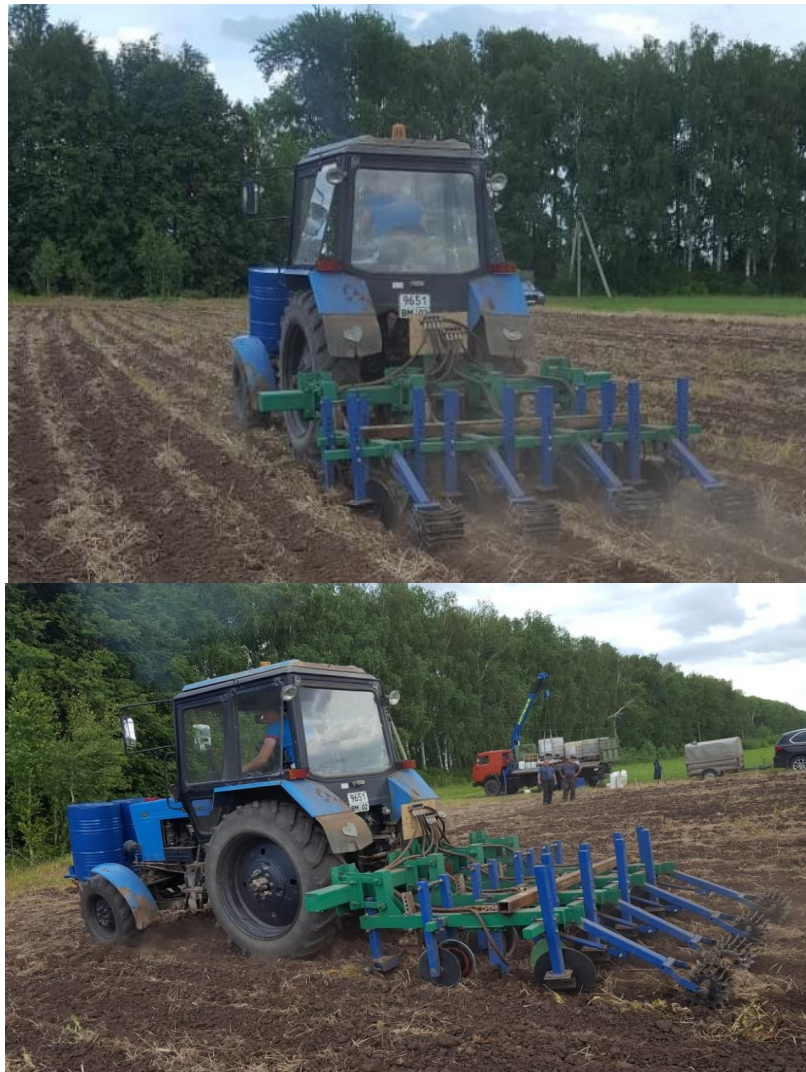
Рисунок 3.2 – Дослідження культиватора в лабораторно-польових умовах
