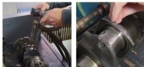
Процес намагнічування шийки колінчатого валу та використання сухого методу контролю
