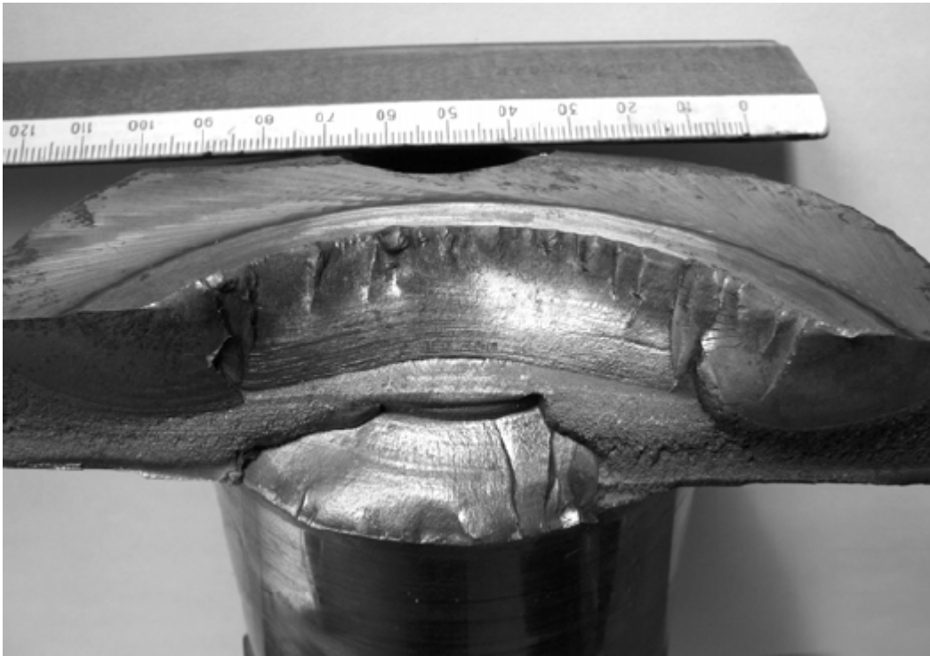
Рисунок 2.1 – Форма втомного руйнування шийки колінчатого валу
