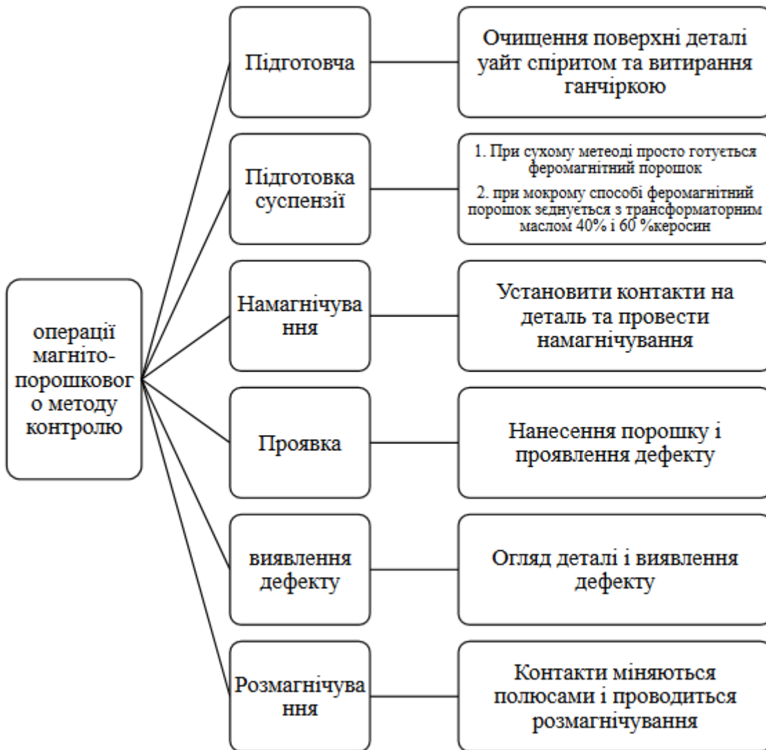
Рисунок 3.2 – Послідовність операцій магнітопорошкової дефектоскопії
