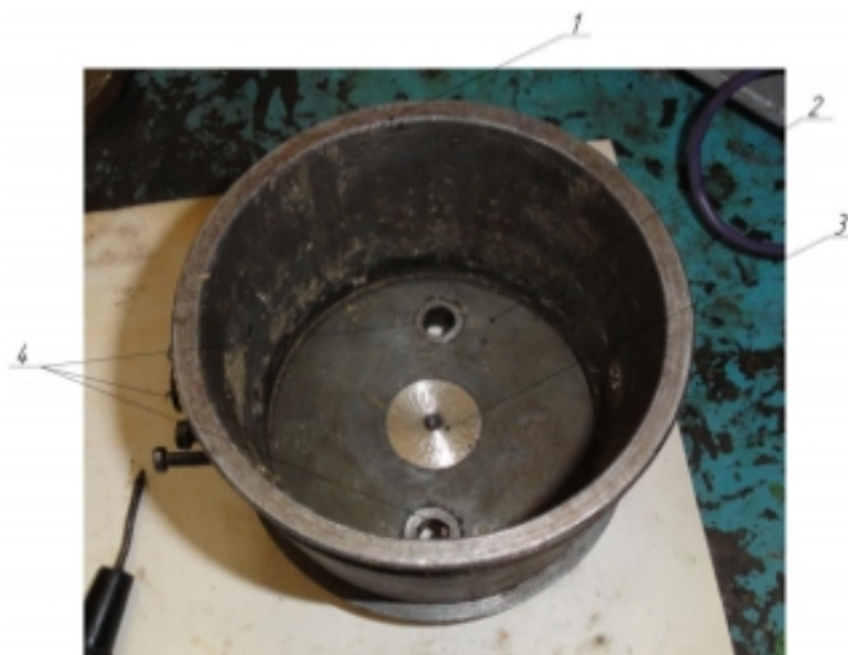
Рисунок 3.2 – Фото компресійної камери в розібраному вигляді: 1 – циліндр; 2 – суцільне дно з датчиками; 3 – отвір для датчиків
