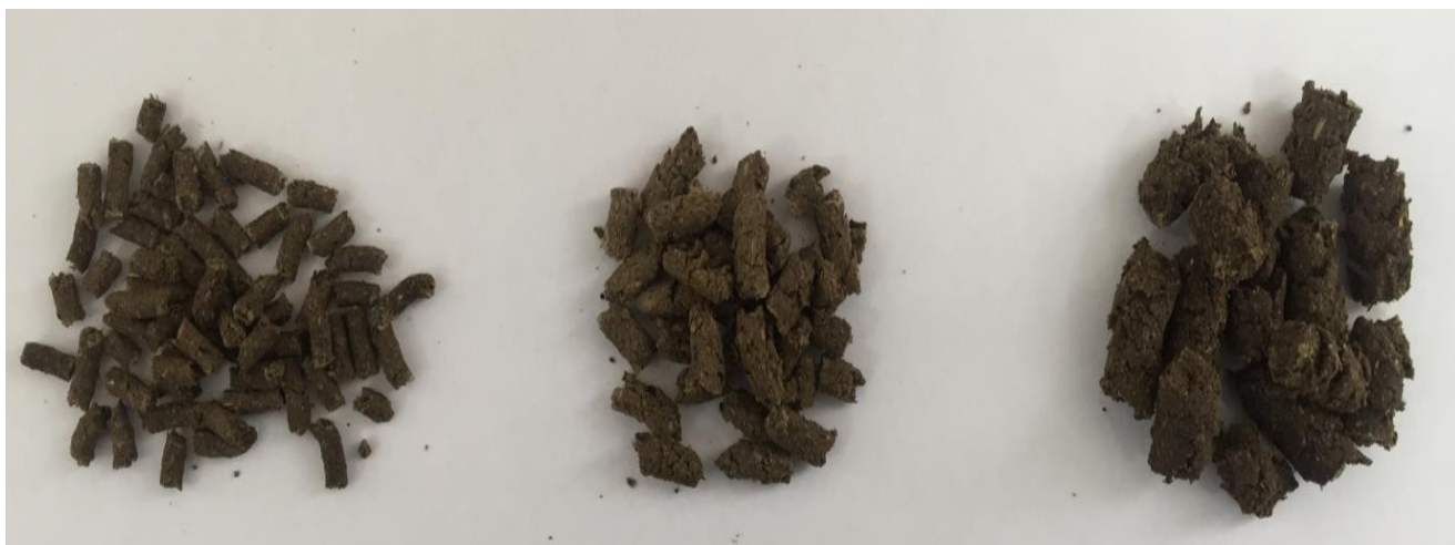
Рисунок 4.8 – Фотографія отриманих гранул для матриці різних діаметрів вихідних отворів d = 2; 5 і 10 мм
