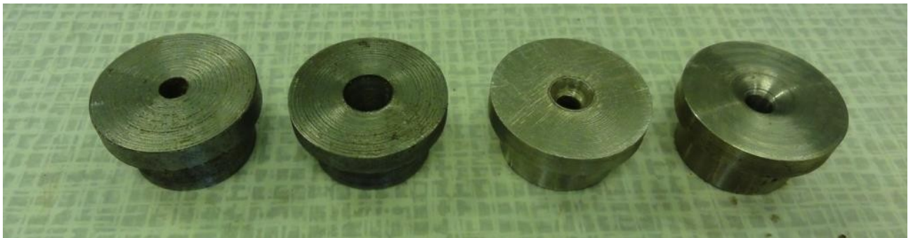
Рисунок 3.9 – Фото плашок з гранулюючими отворами: а – циліндрична; б – циліндрична з конічним входом; в – конічне звуження; г – експериментальна
