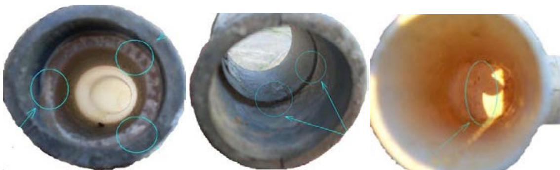
Рисунок 1.2. – Фрагменти механічних забруднень на окремих ділянках молокопроводних систем
