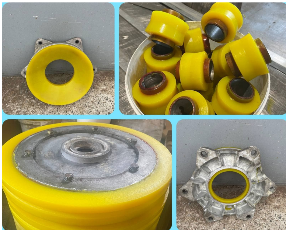
Рисунок 1.2 – Деталі із поліуретановим покриттям робочих поверхонь
