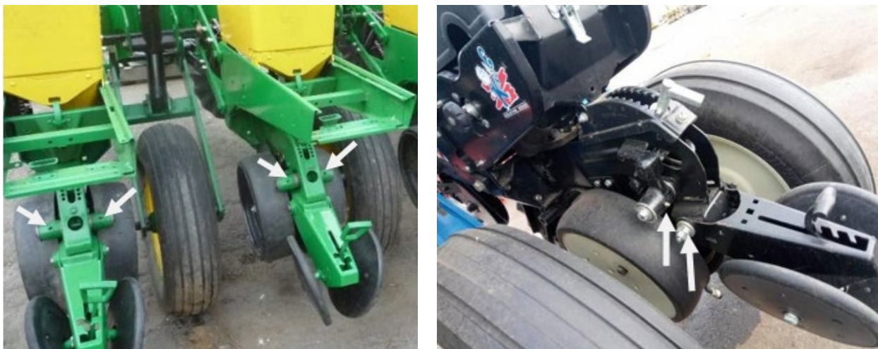
Рисунок 1.3 – Сівалки та точки мащення їх рухомих з'єднань
