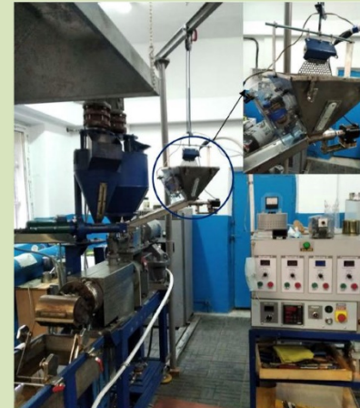
Рис. 7 – Екструдер із системою для подачі вуглецевого волокна із високою точністю дозування
