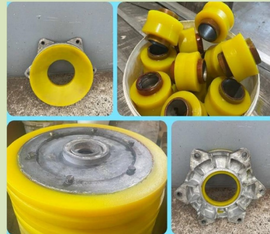
Рис. 3 – Деталі із поліуретановим покриттям робочих поверхонь
