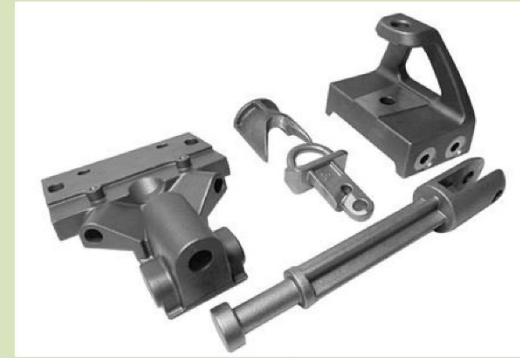
Рис. 1 – Деталі із нанесеними захисними покриттями: а – на основі хрому; б – на основі цинку
