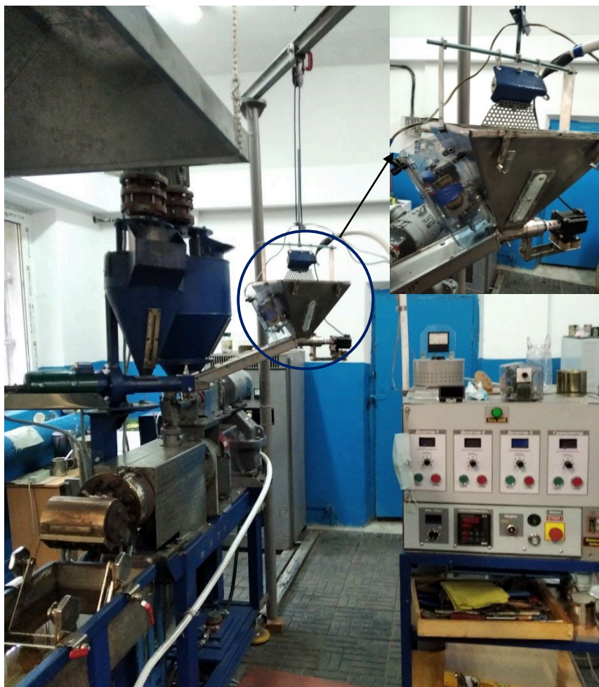
Рисунок 2.2 – Екструдер із системою для подачі вуглецевого волокна із високою точністю дозування
