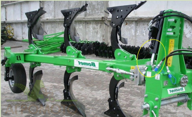
Рис. 2 – плуг із гідроциліндрами, штоки яких мають нанесення покриття на основі хрому
