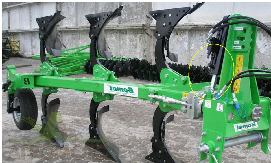
Рисунок 1.2 – Культиватор та плуг із гідроциліндрами, штоки яких мають нанесення покриття на основі хрому
