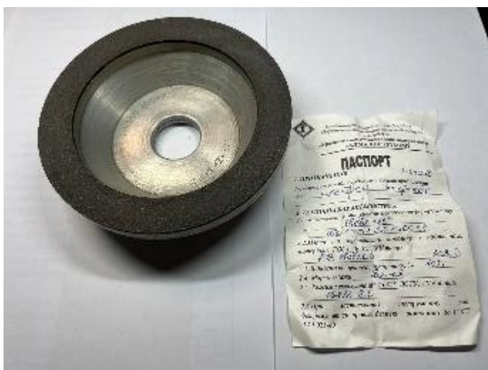
Рисунок 2.2 – Шліфувальний круг з КНБ на полімерній зв'язці В2-08
