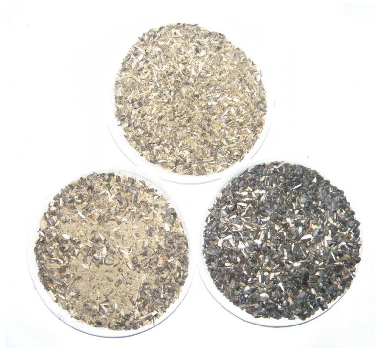
Рис.3.2. Фракції, отримані після сепарації зерноsumіші соняшнику (табл.3.1 дослід № 13)
