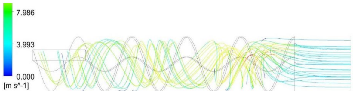
Рисунок 2.7 – 3D симуляція роботи пневматичного шнекового сепаратора (траєкторії руху повітряного потоку, швидкість повітряного потоку, м/с)
