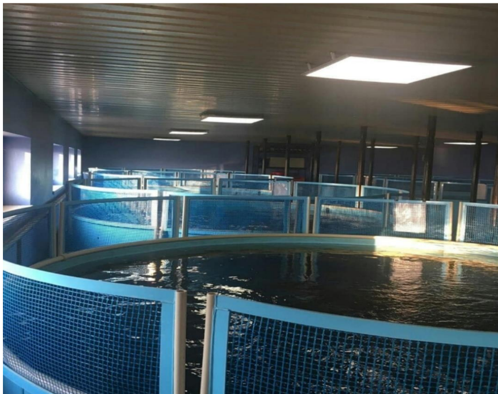
Рис. 1. УЗВ для вирощування осетрів
