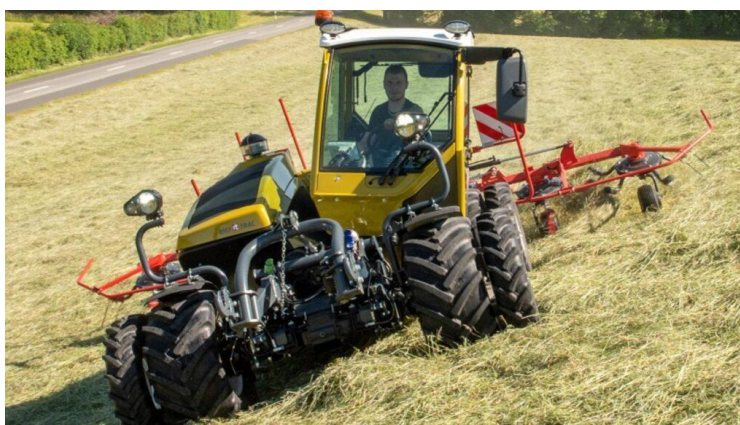
Рис. 2.4. Трактор Rigitrac SKH 60 для роботи на схилах
