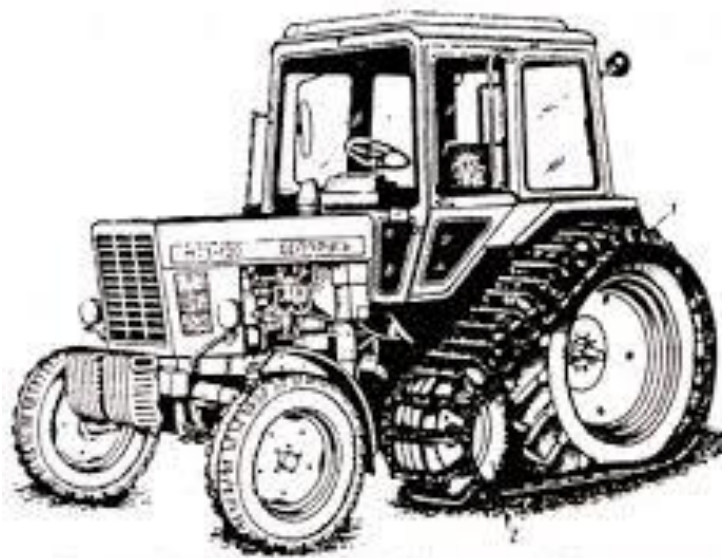
Рис. 2.11. Використання легкої гусениці для підвищення прохідності універсально-просапного трактора
