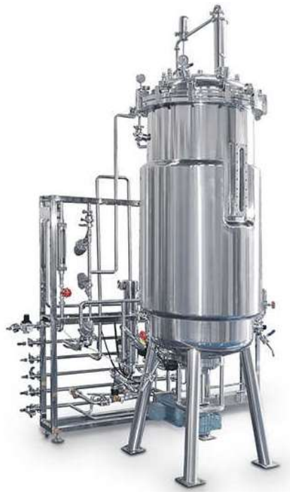
Рис. 25. Біореактор з бульбашковою колонкою (Китай) [28]
