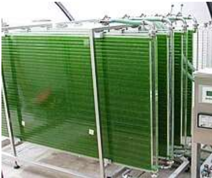
Рис. 31. Фотобіореактор із пластикових пластин [34]
