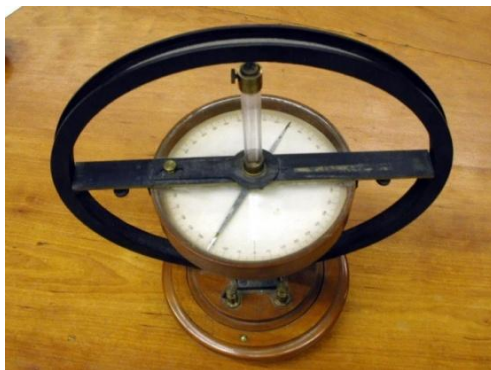
Рис. 5 Принципова схема та зображення тангенс-гальванометра
