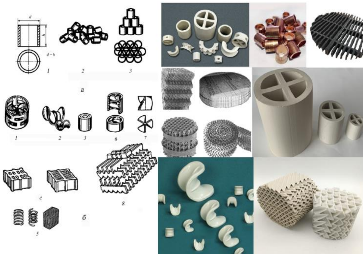
а – кільця Рашига: 1 – окреме кільце, 2 – кільця навалом, 3 – регулярна насадка; б – фасонна насадка, 1 – 2 – 3 – кільця з хрестоподібними перегородками, 4 – керамічні блоки, 5 – кручені з дроту насадки, 6 – кільця з внутрішніми спіралями, 7 – пропелерна насадка, 8 – хордова насадка Рисунок 2.9. – Види насадки
