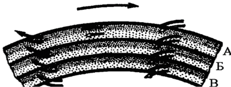
Рисунок 4.14 – Схема руху рідини в каналах барабана відцентрового екстрактора
