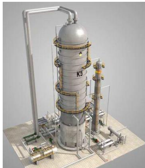
Рисунок 1.27. – Схема установки для екстрактивної ректифікації бінарної суміші
