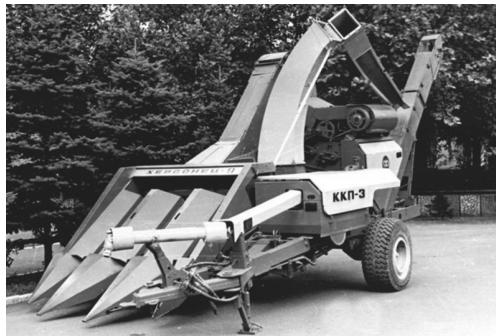
Рис. 9.1. Комбайн кукурудзозбиральний причіпний ККП-3 «Херсонець-9».
