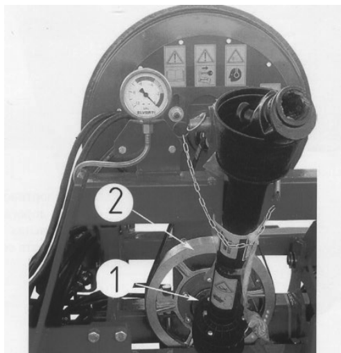
Рис. 4.6. Привід вентилятора: 1 – відцентрова муфта, 2 – шків вентилятора
