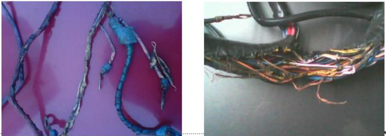
Рисунок 1.5 - Оплавлення обмотки внаслідок замикання свічки накалювання на масу
